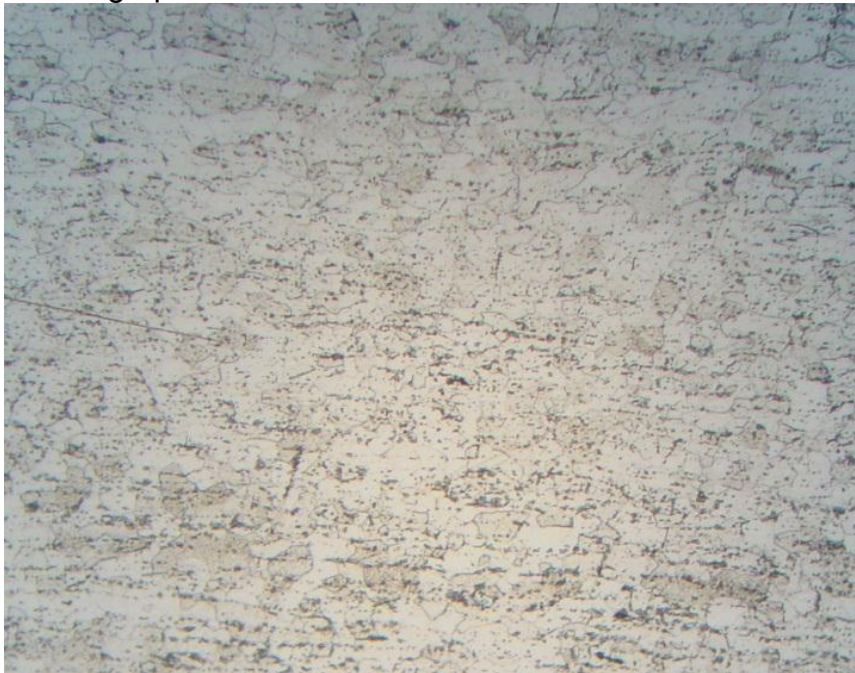
Figure 3.3.d Micrographie d'un échantillon déformé à 75% suivi d'un recuit à 700°C
