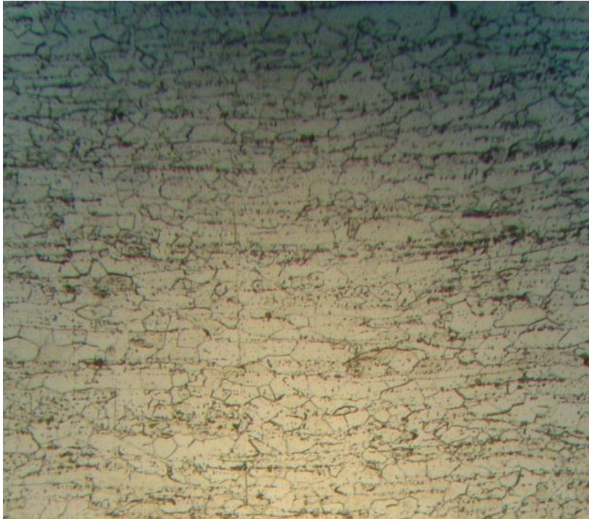
Figure 3.2.a Micrographie d'un échantillon déformé à 15% suivi d'un recuit à 600°C
