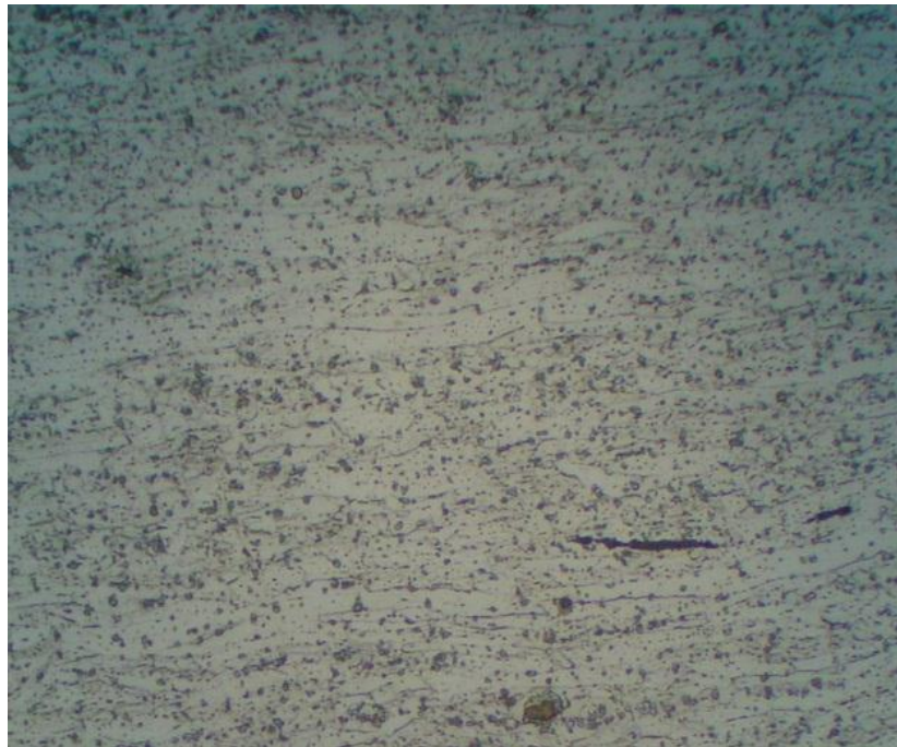
Figure 3.2.d : Micrographie d'un échantillon déformé à 75% suivi recuit à 600°C
