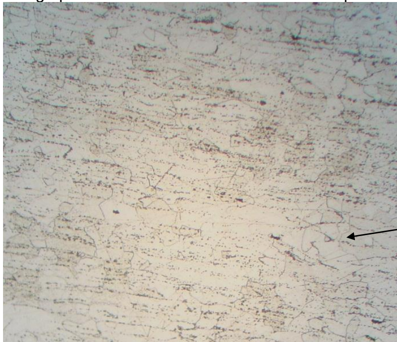
Figure 3.3.b Micrographie d'un échantillon déformé à 30% suivi d'un recuit à 700°C
