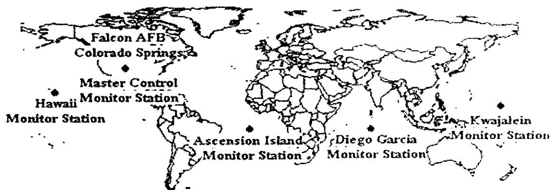
Figure(II-6): Le segment de controle du GPS
