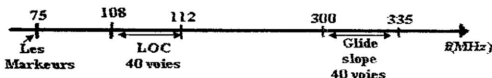
Figure (I-8): Plan de fréquences de l'ILS en MHz
