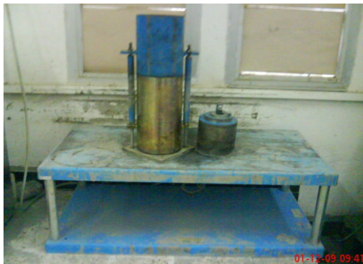
Figure 2.4: Mode de vibration des éprouvettes.
