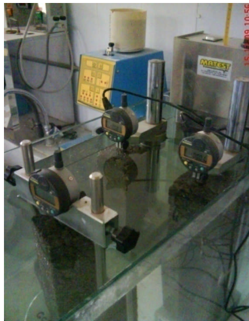
Figure 2.14: Mesure du Gonflement.
