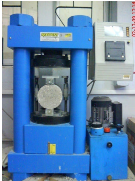
Figure 2.10: Essai de traction par fendage sur éprouvettes cylindriques.
