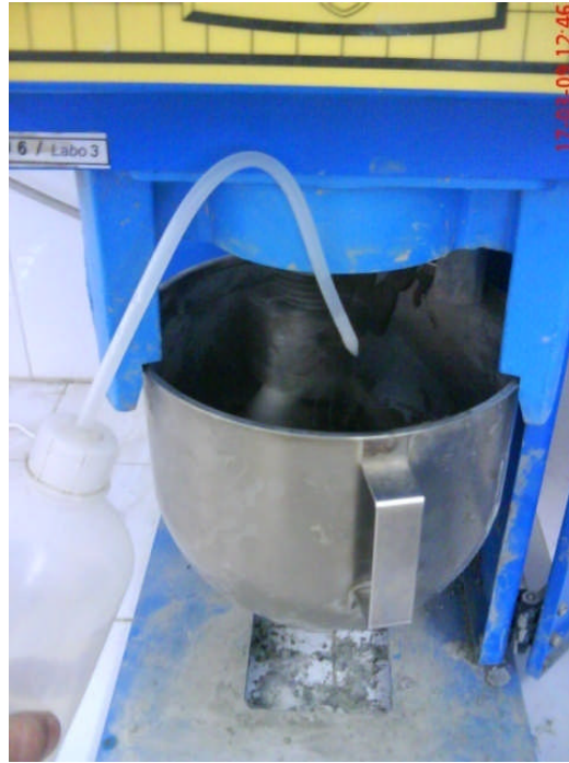
Figure 3.2 : Ajustement de l'eau dans l'essai de demande en eau.
