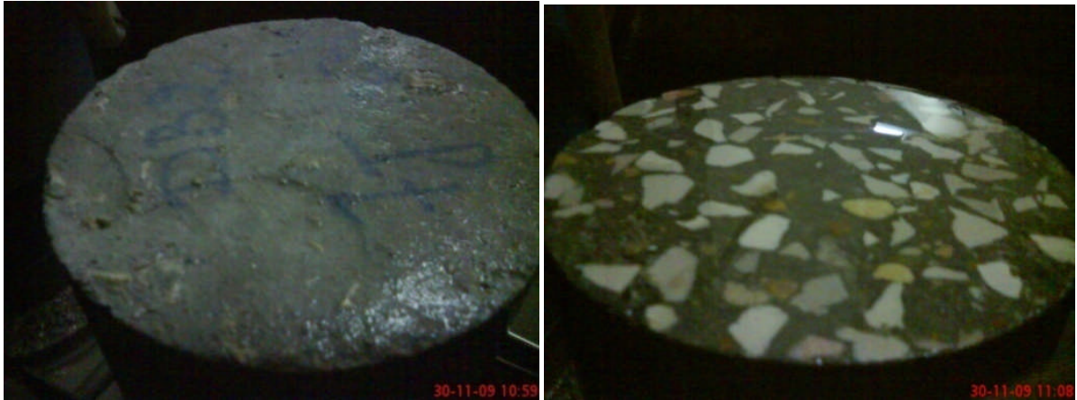
Figure 2.8 : Éprouvette avant et après le surfacage.
