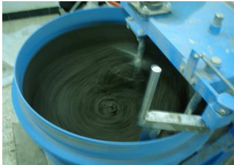
Figure 2.2: Malaxeur à béton de capacité 56 Litres.
