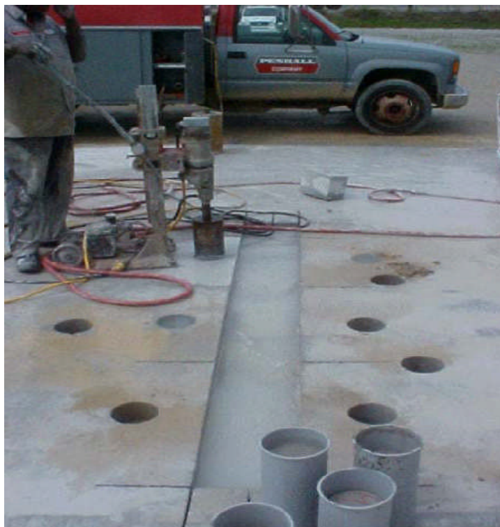
Figure 1.5 : Carottage des éprouvettes cylindriques de BCR [11].
