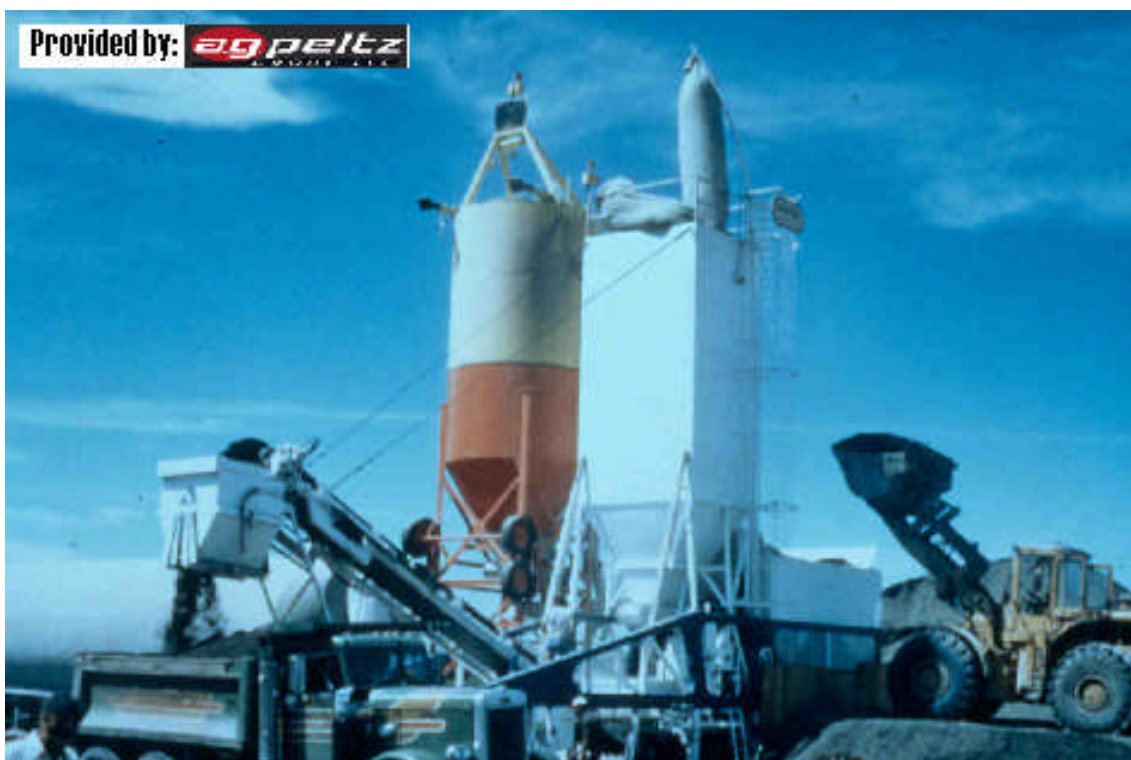
Figure 1.6 : Pugmill pour production de BCR [11].
