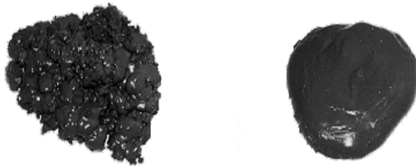
Figure 3.1 : Passage du ciment de l'état de boulettes à l'état de pâte homogène.
