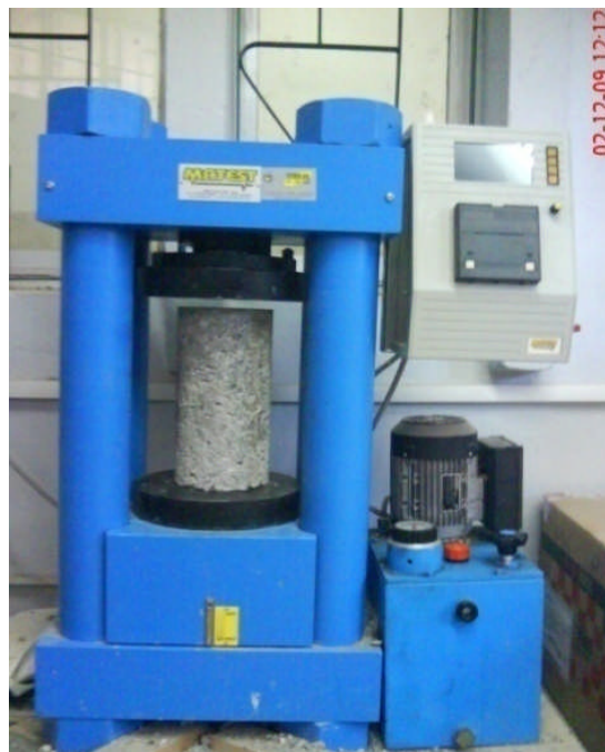
Figure 2.9: Essai de compression sur éprouvettes cylindriques.
