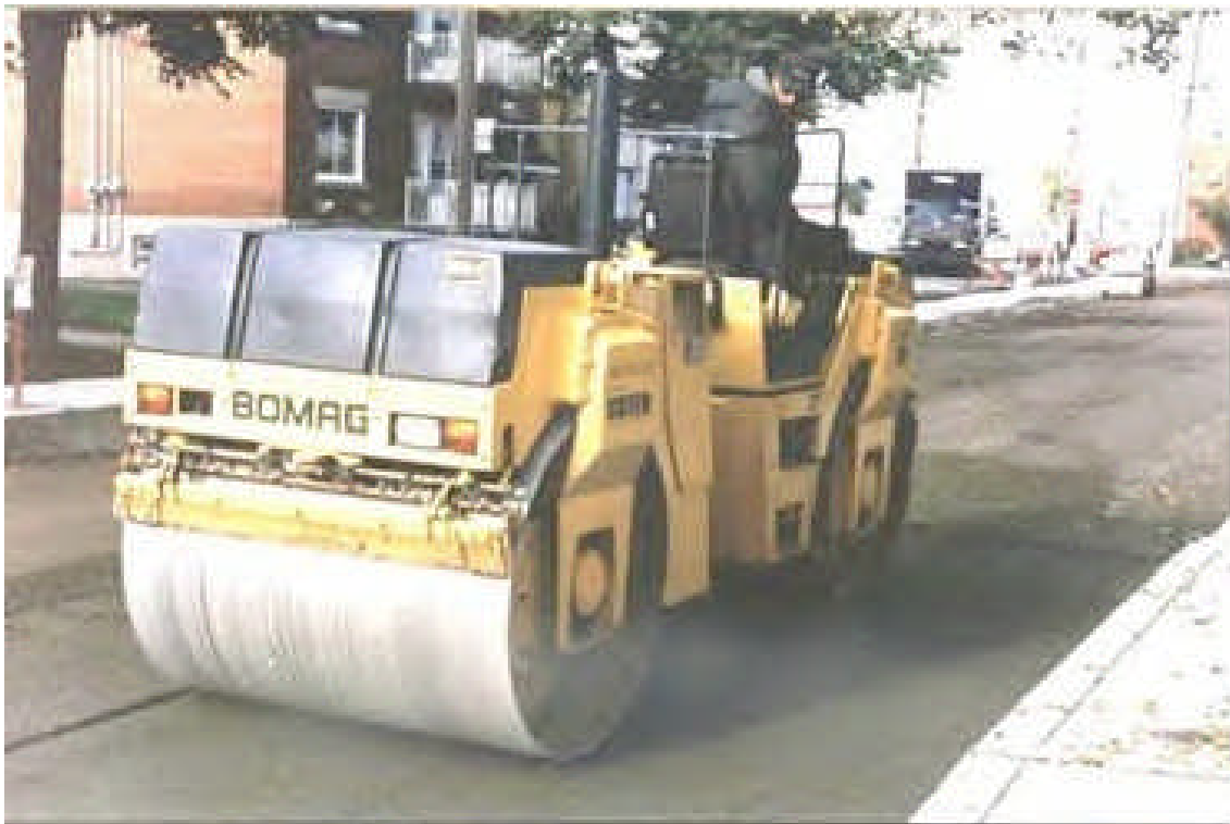
Figure 1.10 : Rouleau compacteur tandem à cylindres métalliques lisses [4].
