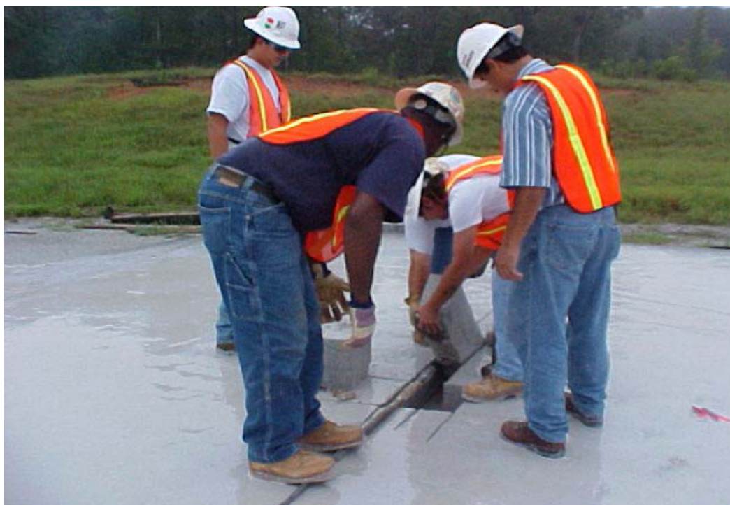
Figure 1.4 : Carottage des éprouvettes de BCR [11].
