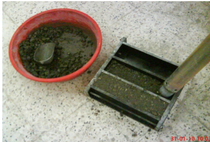
Figure 2.3 : Préparation des éprouvettes pour les mesures du retrait et du gonflement.
