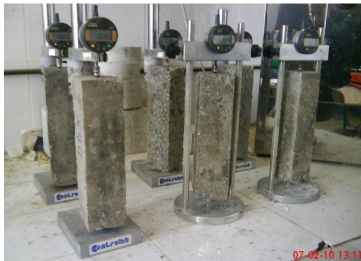
Figure 2.13: Mesure du retrait.
