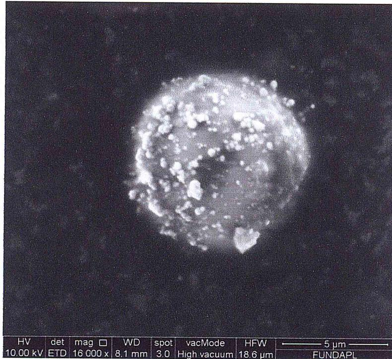
Figure 27: Résultats morphologique (visuels) de particules métalliques de (Pb-Ba-Sb) par (SED) élaboré au niveau du laboratoire de physique appliqué université Blida -1-.
