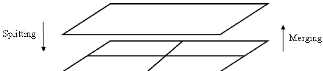
Figure 2.6 : Illustration du concept pyramidal de l'image pour la segmentation par fusion et division de régions
