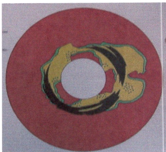
Figure III.6 : Corrosion par frottement.
