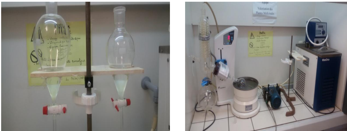
Figure 5 : A. séparation des deux phases. B. évaporation des solvants.
