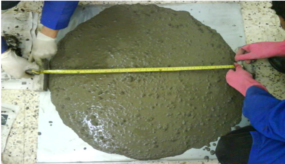
Figure 2.12 : Mesure du diamètre d'étalement.
