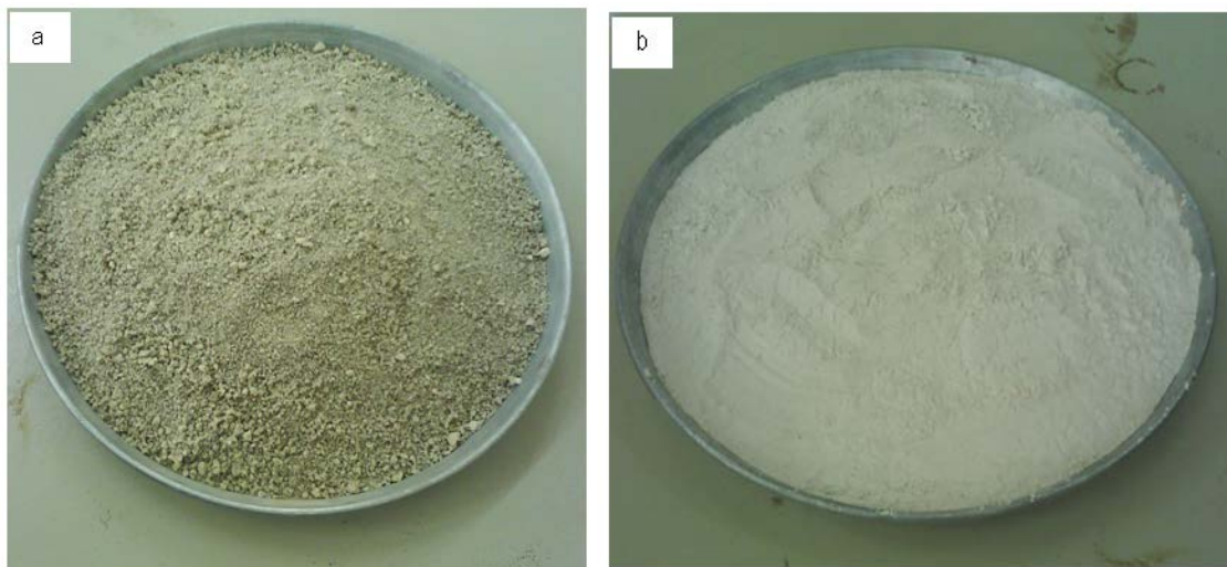
Figure 2.1: Laitier granulé de haut fourneau utilisée, (a) avant broyage, (b) après broyage.
