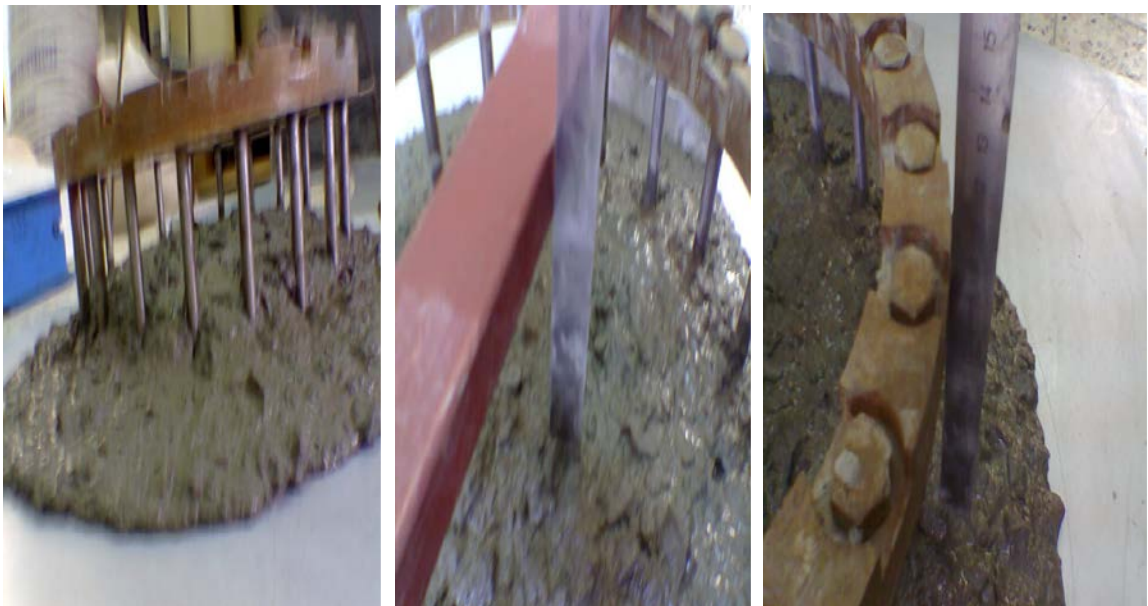
Figure 2.16 : Mesure des hauteurs à l'intérieur et à l'extérieur du J-Ring.
