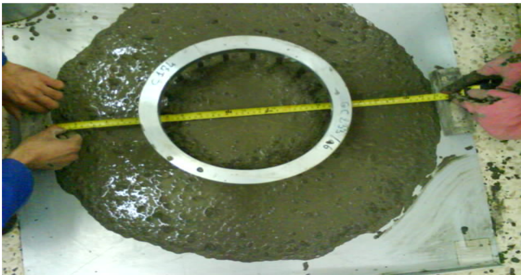
Figure 2.15: Mesure d'étalement en présence du J-Ring.
