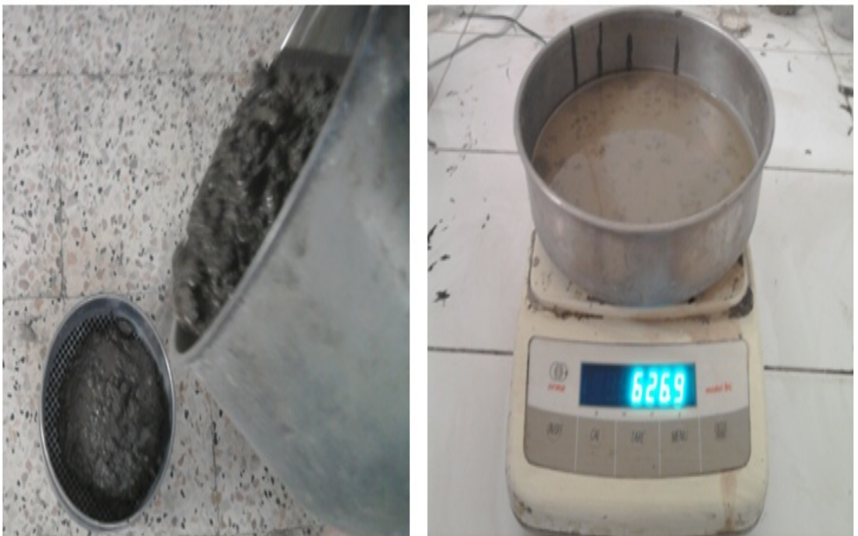
Figure 2.19 : Essai de résistance à la ségrégation au tamis.
