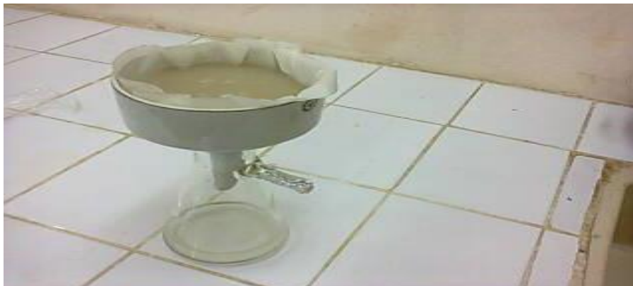
Photo 9 : Filtration et lavage de la suspension argileuse pontée.
