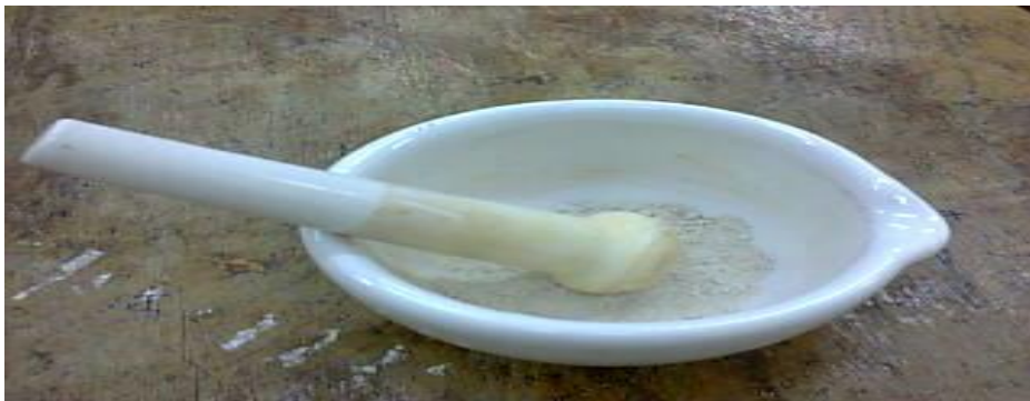
Photo 11 : Broyage du solide avec un mortier.
