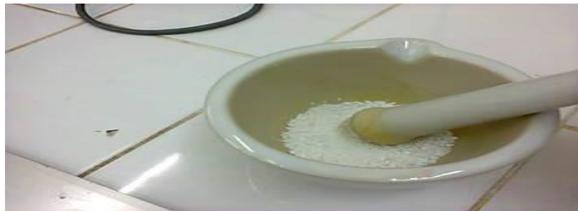
Photo 5 : Broyage du solide avec un mortier.
