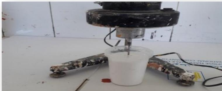
**Figure 10 :** viscosimètre BROOKFIELD.
