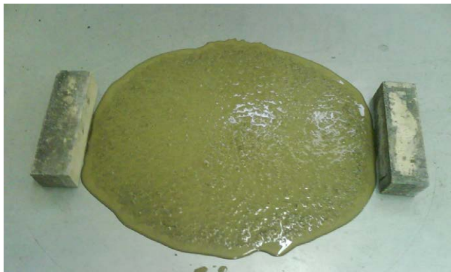
Figure 3.1 : Présence de ressuage dans le mortier pour des valeurs de SP/L de 2% et 2,2%.
