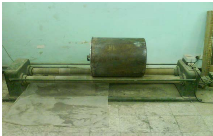
Figure 2.2 : Broyeur à boulets.
