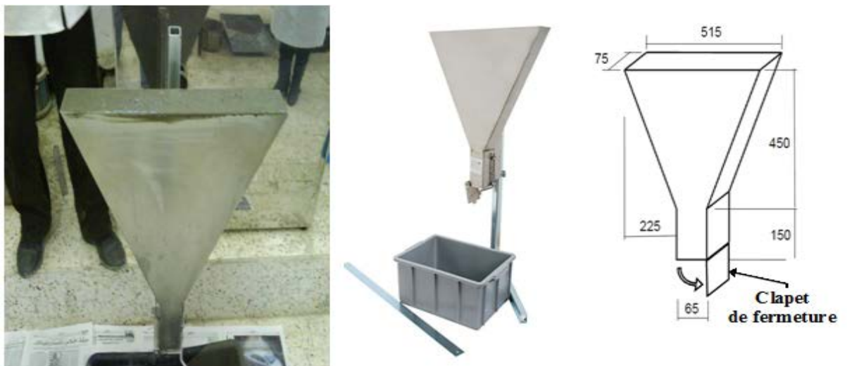
Figure 2.12 : Entonnoir en V (V-Funnel) pour les BAP
