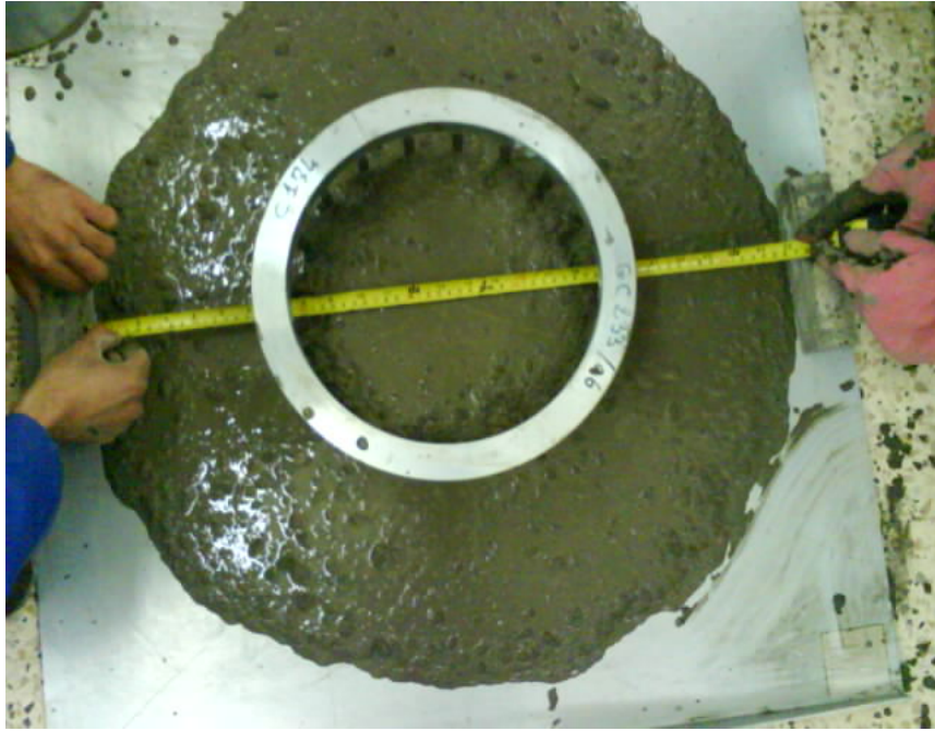
Figure 2.16: mesure d'étalement en présence du J-Ring.
