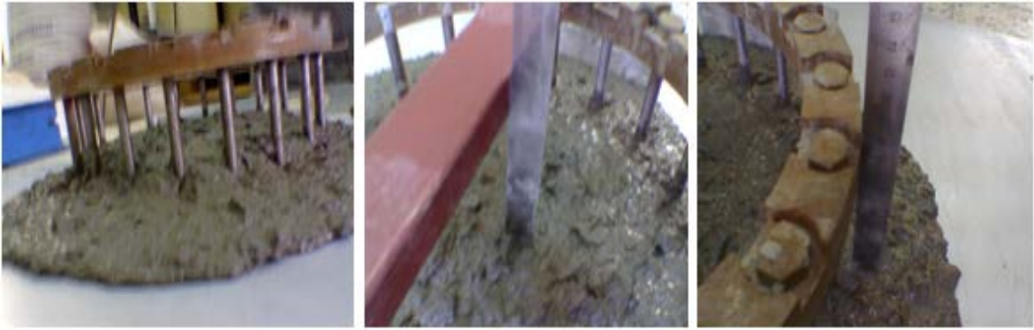
Figure 2.17: Mesure des hauteurs à l'intérieur et à l'extérieur du J-Ring.
