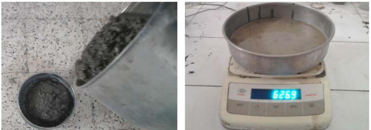
Figure 2.19 : Essai au tamis.
