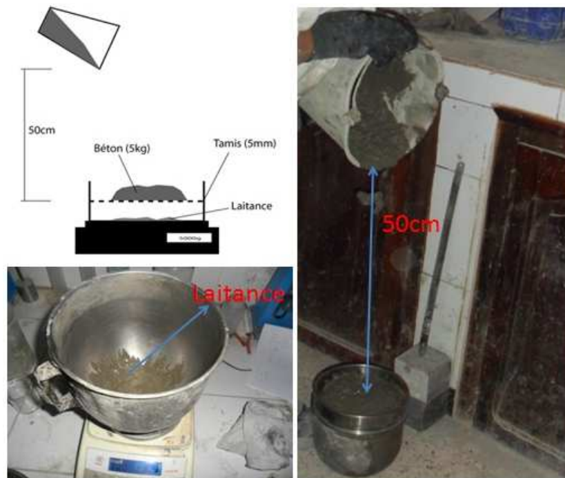
Figure 2.11 : Essai de stabilité au tamis.
