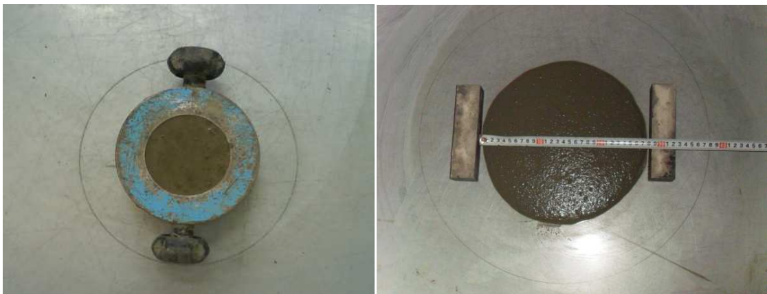
Figure 2. 5: Essai d'Etatement pour Mortier.
