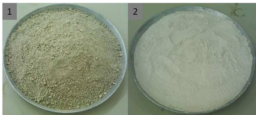
Figure 2.1: Laitier granulé de haut fourneau utilisée : (1) avant broyage, (2) après broyage.
