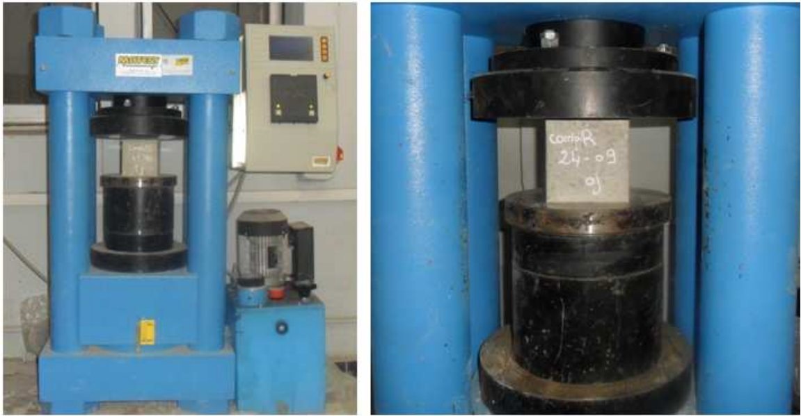
Figure 2.12 : Dispositif de l'essai de compression simple.
