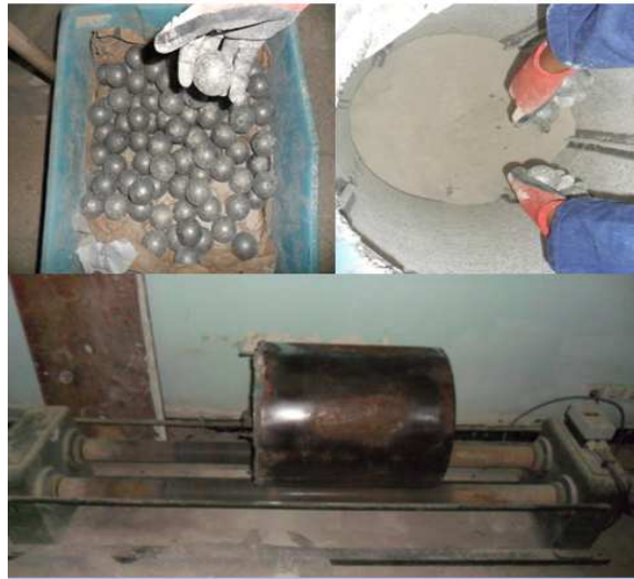
Figure 2.2: Broyeur à boulet utilisé.
