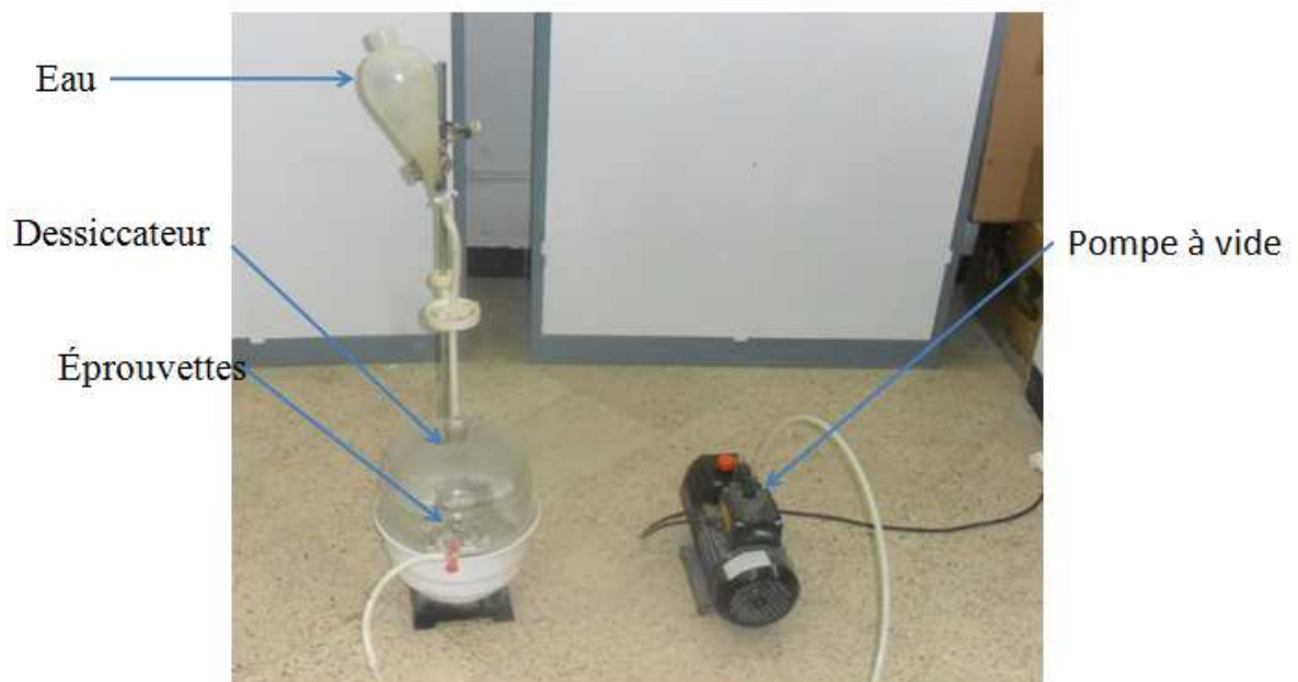
Figure 2.17 : Dispositif de saturation sous vide des éprouvettes
