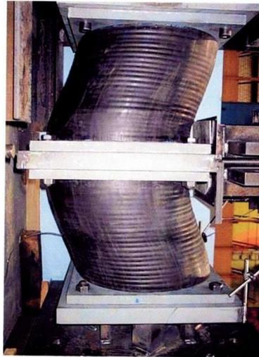
**Figure 1.5:** Les appuis élastomères soumis à l'essai dynamique de cisaillement
