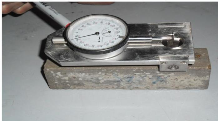
Figure 3.16 : Appareil pour mesurer d'expansion des mortiers
