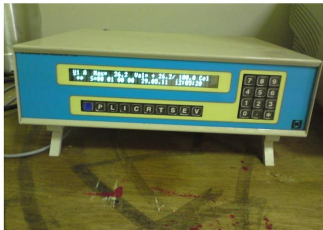
Figure 3.12 : Boîte d'acquisition des températures
