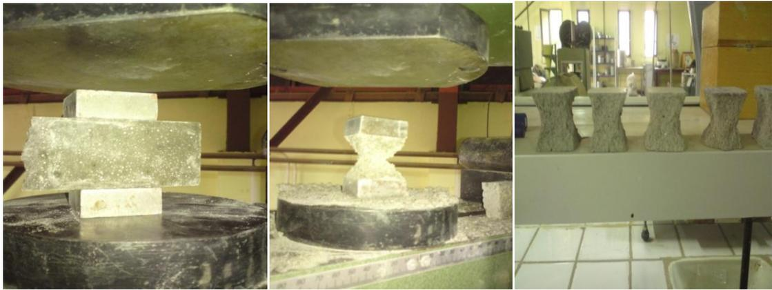
a) Eprouvette avant écrasement b) Eprouvette après écrasement c) forme des prismes écrasés
