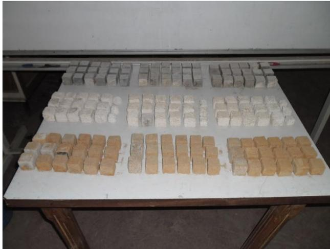
Figure 3.15 : Vue générale des éprouvettes immergées dans les solutions de 1% HCl et 3% H<sub>2</sub>SO<sub>4</sub>
