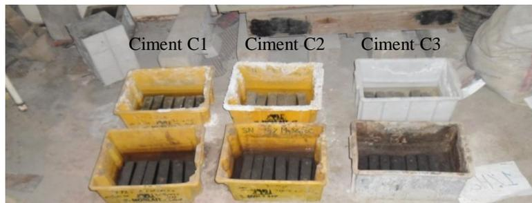
Figure 3.13: Immersion des éprouvettes dans la solution de sulfate de magnésium (5% $MgSO_4$ ).
