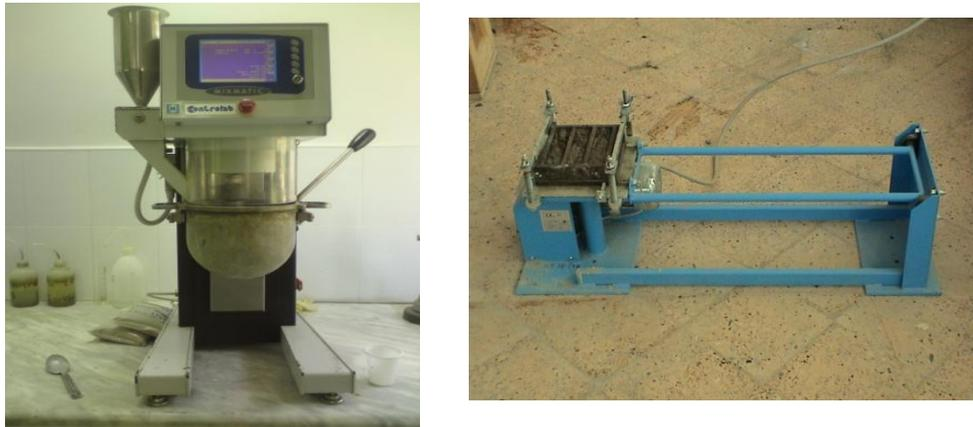
Figure 3.5 : a) Malaxeur de capacité 5 litre    b): Table vibrante pour mortier.
