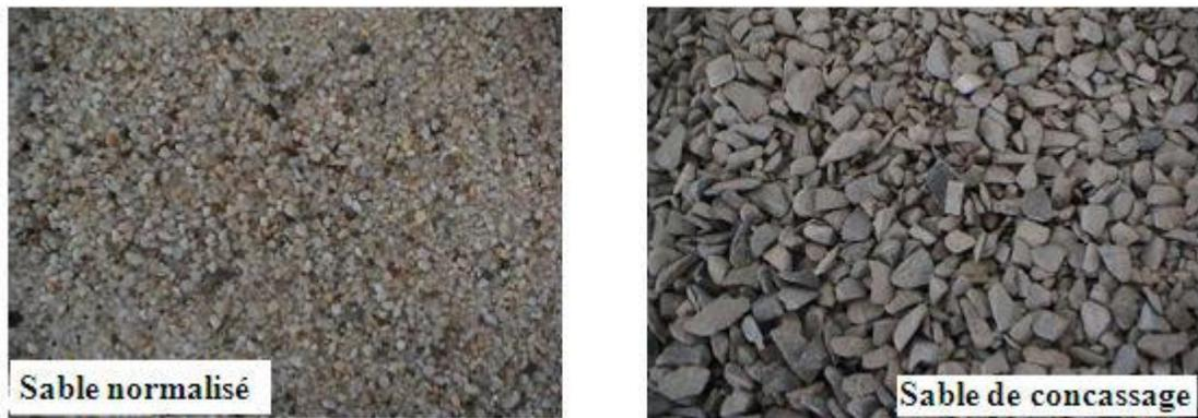
Figure 3.4: Texture de la surface du sable normalisé et concassé.
