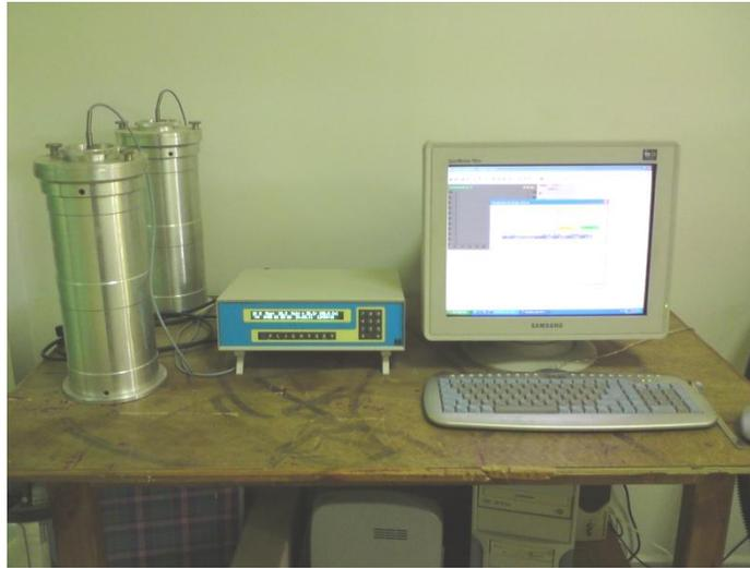
Figure 3.10 : Dispositif utilisé pour mesurer la chaleur d'hydratation
