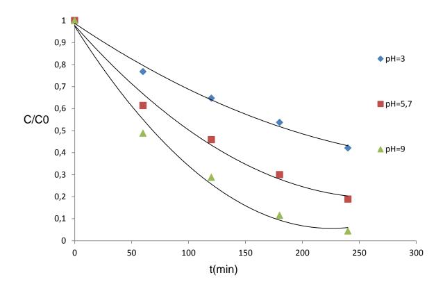
Figure 5.17 : Sono-photodégradation sous 20 kHz du Rhodamine 6G par  $TiO_2$  (1 g.L<sup>-1</sup>) à différents pH
