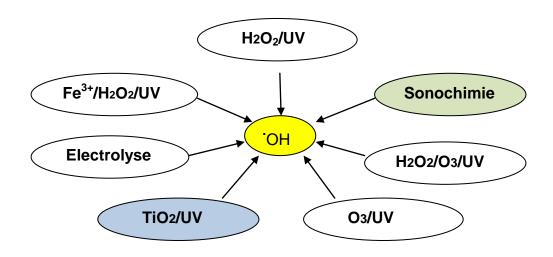
Figure 2.1 : Principaux Procédés d'Oxydation Avancé
