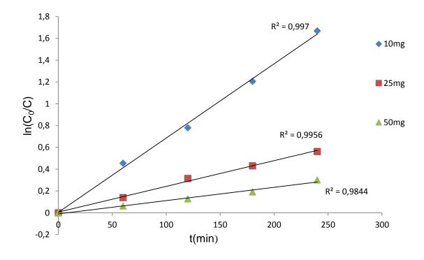
Figure 5.16 : Cinétique de sono-photodégradation de colorant R6G à différentes concentrations du polluant
