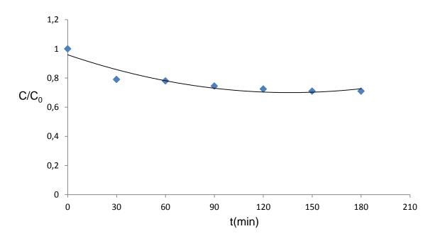
Figure 5.4 : Adsorption du Rhodamine 6G (10 mg.L<sup>-1</sup>)en présence de TiO<sub>2</sub> (1g.L<sup>-1</sup>)
