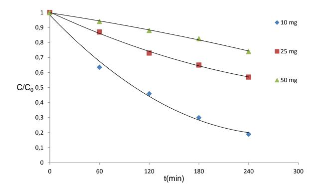
Figure 5.15 : Sono-photodégradation sous 20 kHz du Rhodamine 6G par  $TiO_2$  (1 g.L<sup>-1</sup>) à différents concentrations du polluant
