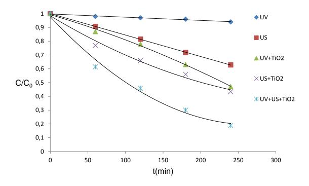
Figure 5.11: Evolution de la concentration normalisée du Rhodamine 6G en fonction du temps pour différents procédés (US à 20 kHz et 30W, 250 W/m², pH=5,7, T=20°C, [R6G]<sub>0</sub>=10 mg.L<sup>-1</sup>
