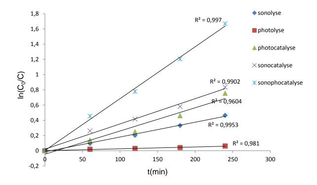
Figure 5.12 : Cinétique de dégradation du Rhodamine 6G par sonolyse, photocyse, photocyse, sonocatalyse et sonophotocyse,
