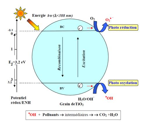
Figure 2.2 : mécanisme de photocatalyse
