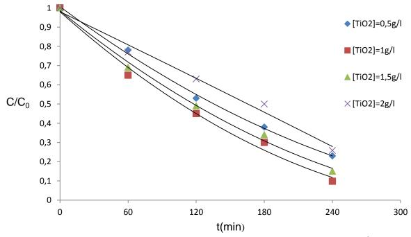
Figure 5.6: Dégradation photocatalytique de la Rhodamine 6G (10 mg.L<sup>-1</sup>) par TiO<sub>2</sub> à différents concentrations
