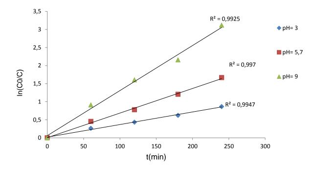
Figure 5.18 : Cinétique de sono-photodégradation du Rhodamine 6G à différents pH
