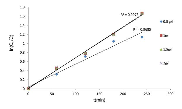
Figure 5.14 : Cinétique de sono-photodégradation de colorant R6G à différentes concentration de TiO<sub>2</sub>
