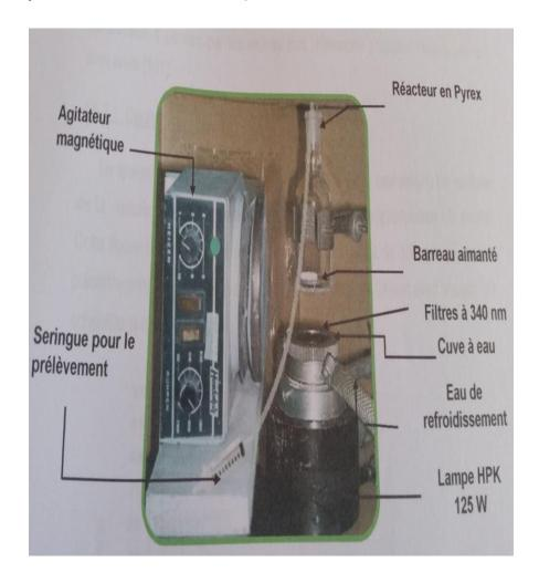
Figure 4.2 : schéma descriptif du photoréacteur
