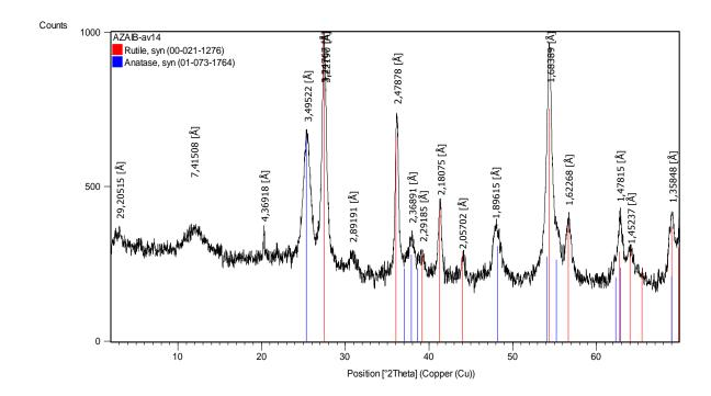
Figure 5.1 : Diffractogramme DRX de TiO<sub>2</sub> calciné a 370°C pendant 1h30min
