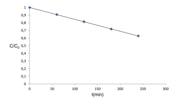
Figure 5.9: Dégradation du Rhodamine 6G (10 mg.L<sup>-1</sup>) par sonolyse
