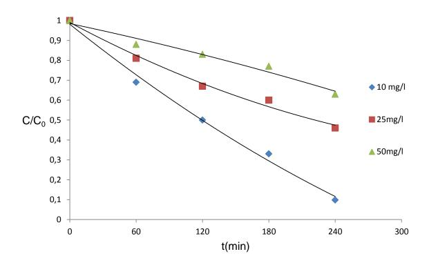
Figure 5.7: Dégradation photocatalytique de la Rhodamine 6G par TiO<sub>2</sub> (1g.L<sup>-1</sup>) à différents concentrations du polluant
