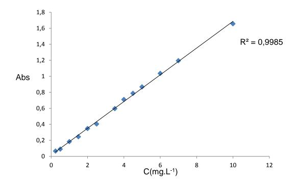
Figure 4.3 : Courbe d'étalonnage du Rhodamine 6G
