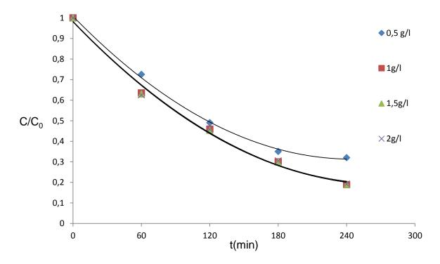
Figure 5.13 : Sono-photodégradation sous 20 kHz du Rhodamine 6G (10 mg.L<sup>-1</sup>) en fonction de la charge de TiO<sub>2</sub>
