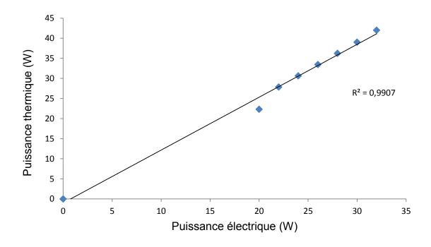
Figure 4.4. : Evolution de la puissance thermique en fonction de la puissance électrique à basse fréquence (20 kHz)
