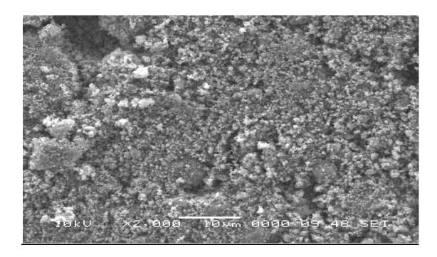
Figure 5.2 : Micrographe MEB de TiO<sub>2</sub> calciné a 370°C pendant 1 h 30 min
