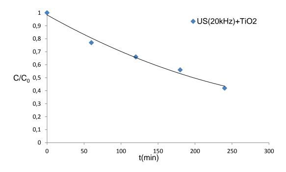
Figure 5.10: Dégradation du Rhodamine6G (10 mg.L<sup>-1</sup>) par sonocatalyse
