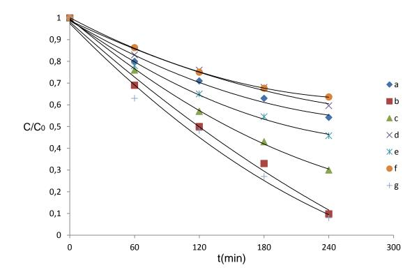
Figure 5.5 : Taux de photodégradation de colorant R6G en fonction du temps : (a) TiO<sub>2</sub> sans calcinations, (b) TiO<sub>2</sub> calciné à 370°C pdt 1h :30min, (c) TiO<sub>2</sub> calciné à 370°C pdt 2 h, (d) TiO<sub>2</sub> calciné à 370°C pdt 3 h, (e) TiO<sub>2</sub> calciné à 400 W pdt 5 min, (f) TiO<sub>2</sub> calciné à 560 W pdt 5 min, (g) Degussa P25
