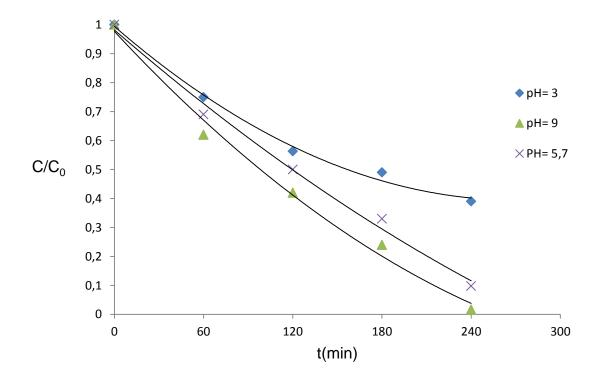
Figure 5.8: Dégradation photocatalytique du Rhodamine 6G (10 mg.L<sup>-1</sup>) par TiO<sub>2</sub> (1g.L<sup>-1</sup>) à différents pH du solution : 3, 5,7 et 9
