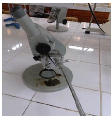
Figure 2.2 : Photos numériques montrant un réfractomètre.
