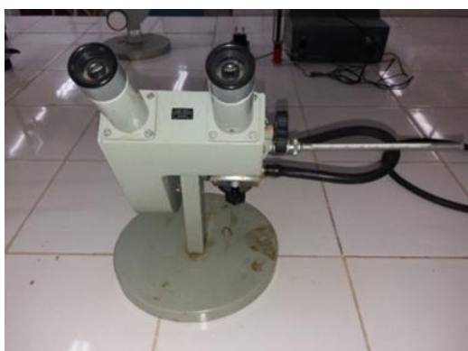
Figure 2.2 : Photos numériques montrant un réfractomètre.
