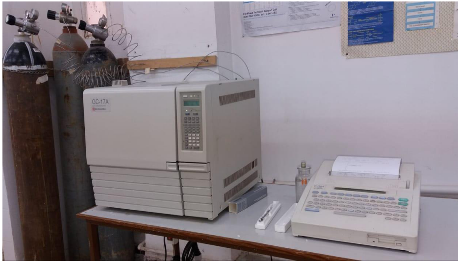
Figure 2.4 : Photographie numérique montrant l'équipement de chromatographie en phase gazeuse utilisé.
