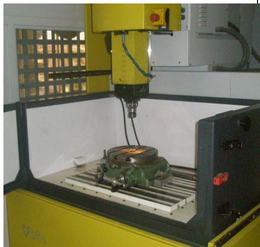
Fixe de repère de la machine suivant de l'axe Z (l'axe vertical)
