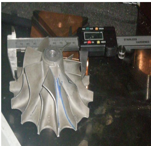
Mesure de l'épaisseur de l'aube en utilisons le pied à coulisse digital.
