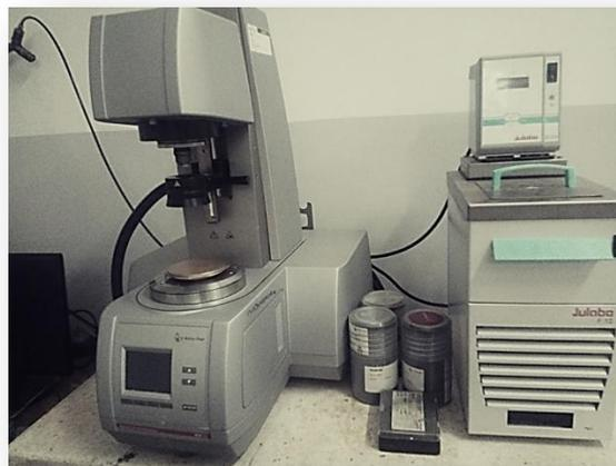
**Figure II.8** : Rhéomètre MCR 302 Anton Paar Physica.
