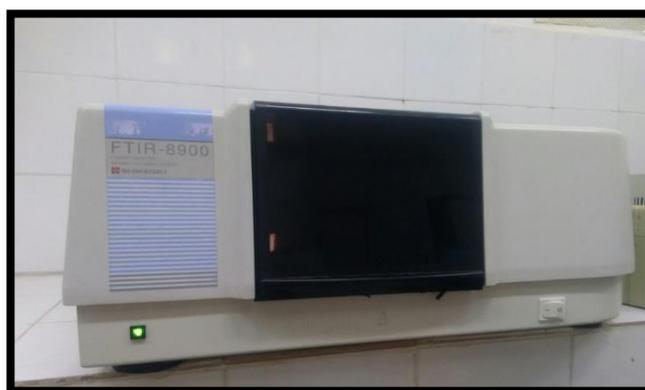
**Figure II.9** : Spectromètre infrarouge Shimadzu
