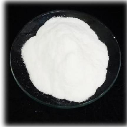
**Figure I.3 :** Présentation de la poudre du polymère Hydroxypropyl méthyl cellulose
