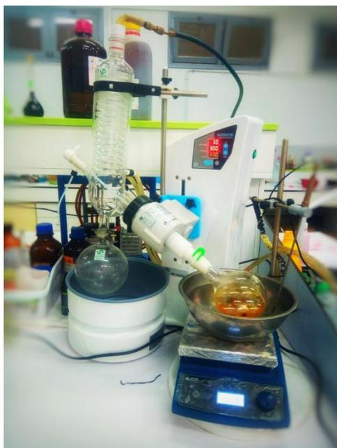
**Figure II.11** : Séparation du solvant avec un rota vapeur
