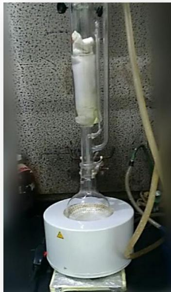
**Figure II.10:** Montage Soxlet pour l'extraction de l'huile de lin
