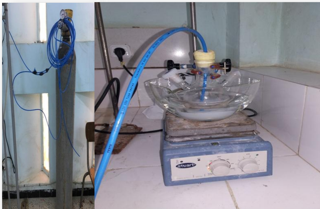
Figure 3.2 : Dispositif expérimental du barbotage.
