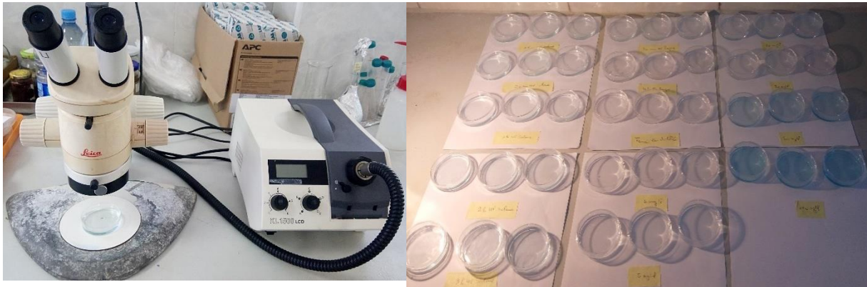
Figure II.6. Photos numérique montrant les boîtes de pétri et la loupe utilisée pour la vérification des mortalités des nauplii
