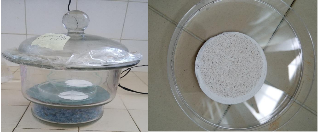
Figure 2. Photo numérique montrant la procédure de mesure de MES au laboratoire
