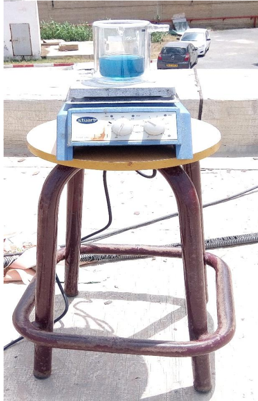
Figure III.13 : Photo numérique montrant le dispositif utilisé dans la photodégradation du VM sous irradiation solaire
