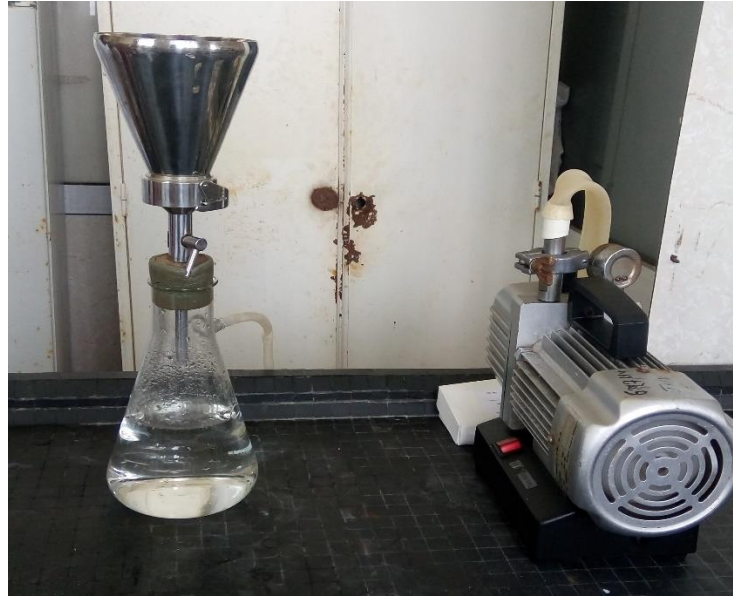
Figure 1. Photo numérique montrant le montage de la filtration sous vide
