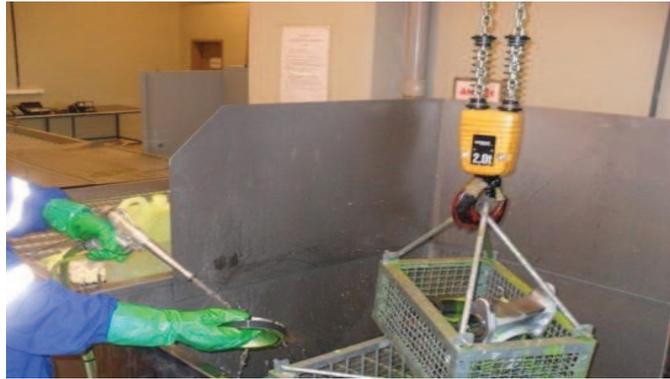
Figure1.11 : Elimination de pénétrant par un lavage adapté après l'application d'un fluorescent.
