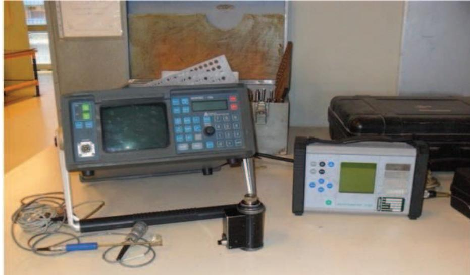
Figure 1.8 : Matériel de CND par courants de Foucault.
