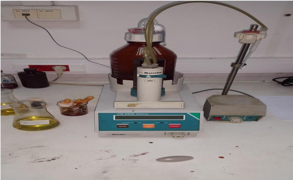
**Annexe A-5 : Appareil de détermination de l'indice d'acidité « par titrage »**
