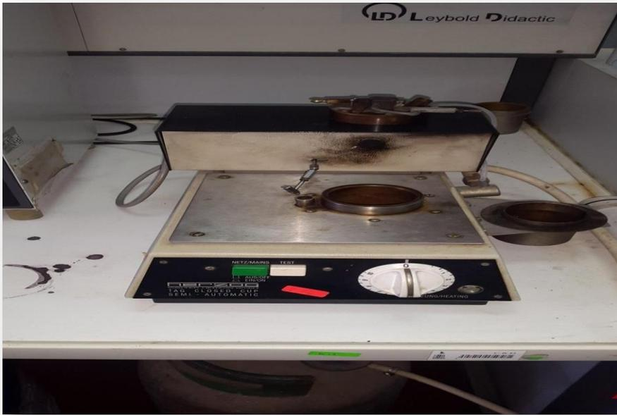
**Annexe A-3: Appareil de détermination de point d'éclair (vase fermé)**
