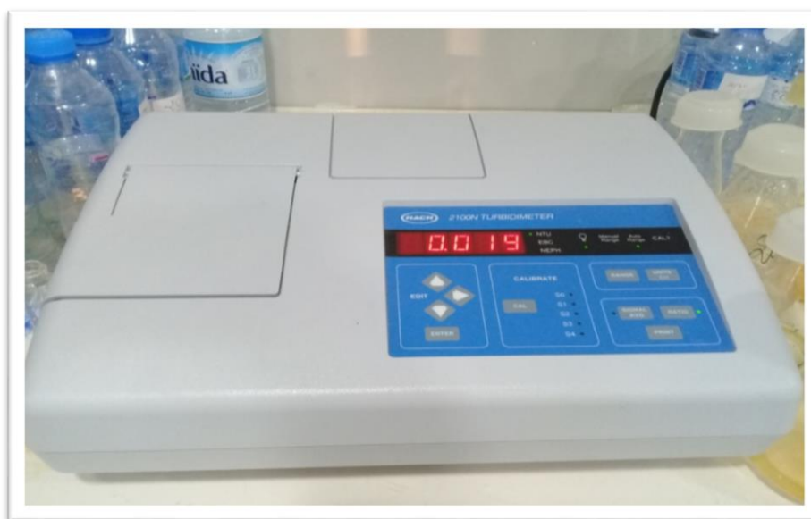
Figure 1.13 : Turbidimètre de laboratoire de traitement des eaux
