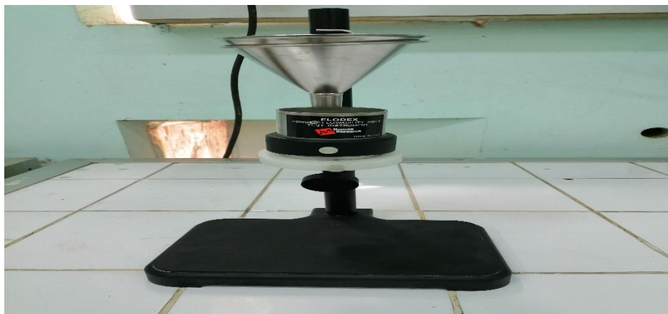
Figure B.6 : Entonnoir normalisé.
