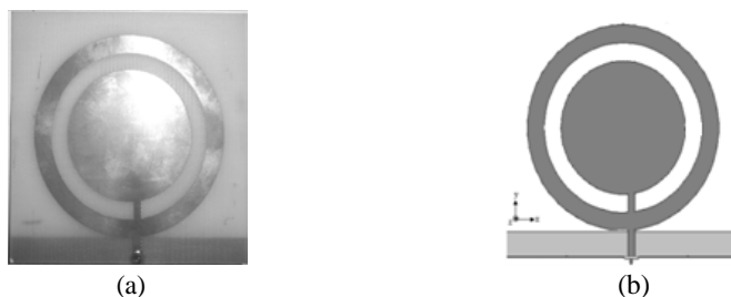
Figure 1.18: Antenne monopôle circulaire, (a) antenne réalisé, (b) layout d'antenne [51].
