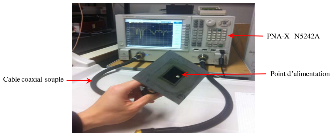
Figure 3.13: Mesure du coefficient de réflexion d'une antenne.
