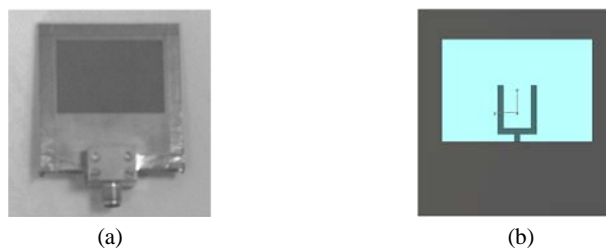
Figure 1.19: Antenne monopôle large fente (a) antenne réalisé, (b) layout d'antenne vue d'arrière [52].
