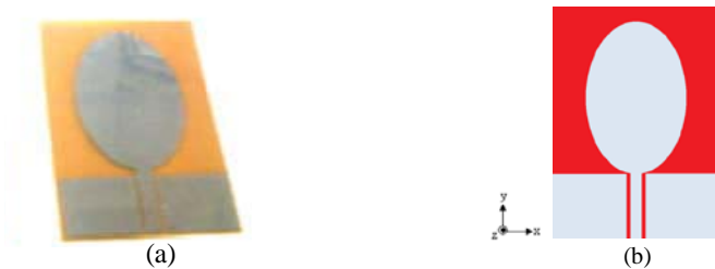
Figure 1.17: Antenne monopôle elliptique, (a) antenne réalisé, (b) layout d'antenne [50].
