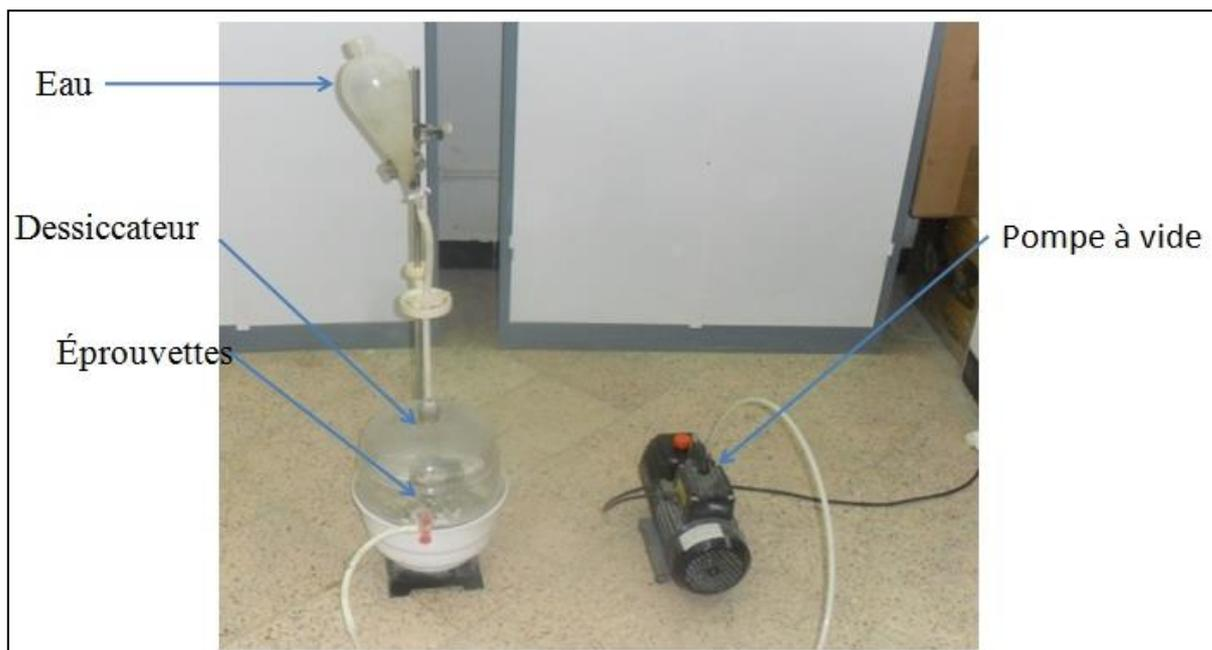
Figure 3.25 : Dispositif de saturation sous vide des éprouvettes.
