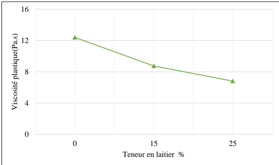
Figure 4.16: Effet du laitier sur la viscosité plastique.
