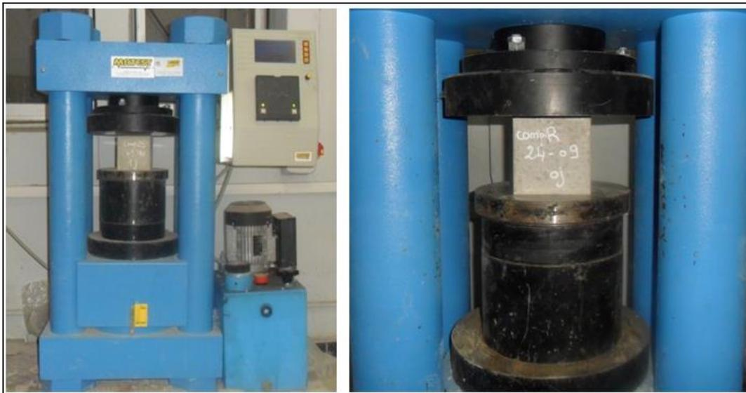
Figure 3.19: Dispositif de l'essai de compression simple.
