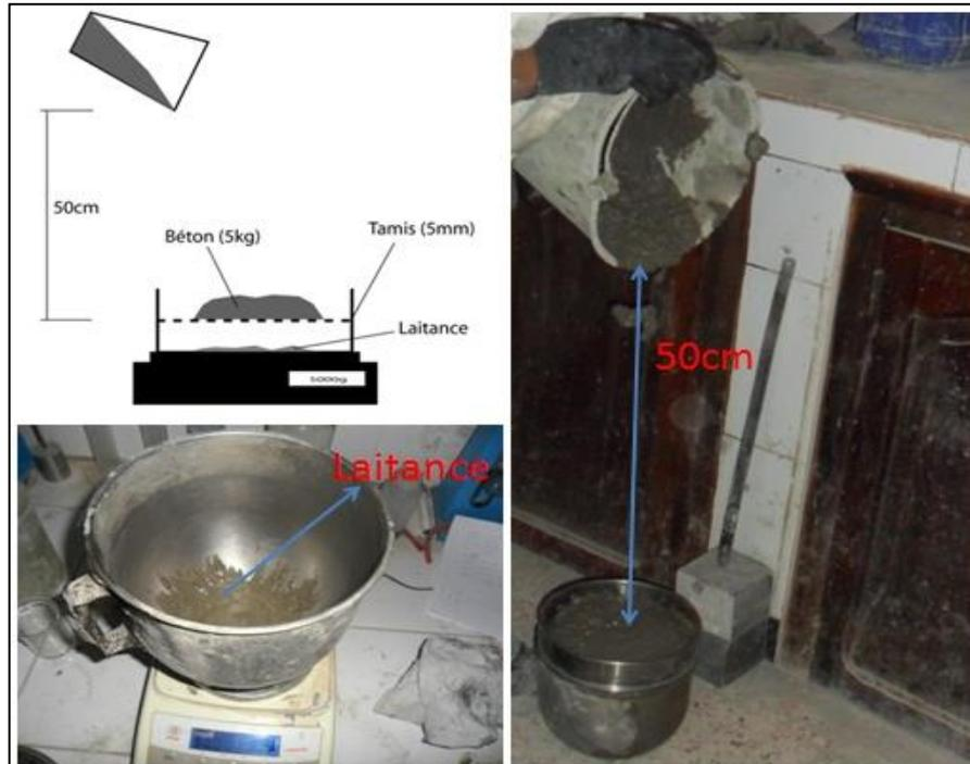
Figure 3.13 : Essai de stabilité au tamis.
