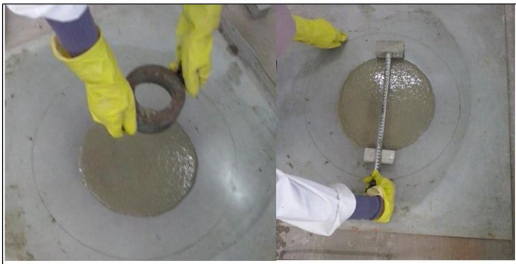
Figure 3.7 : Essai d'Étalement pour Mortier.
