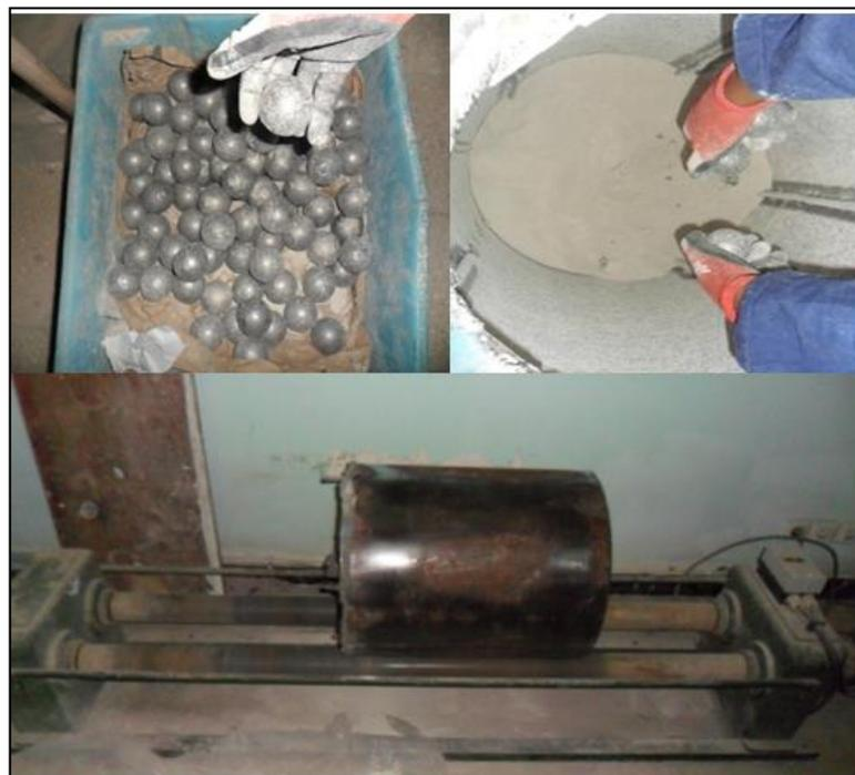
Figure 3.2 : Broyeur à boulet utilisé.
