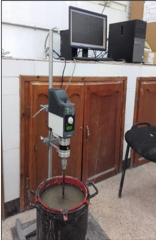
Figure 3.14: Rhéomètre Heidolph-RZR 2102.
