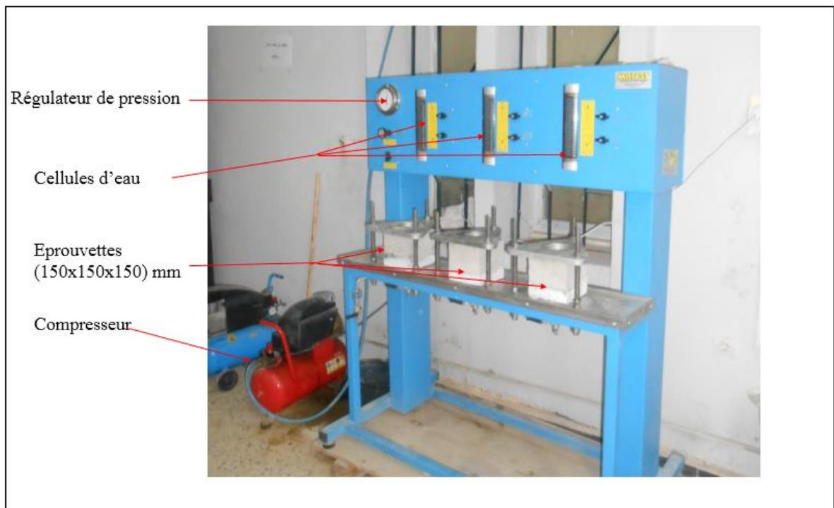
Figure 3.22 : Essai de perméabilité à l'eau.
