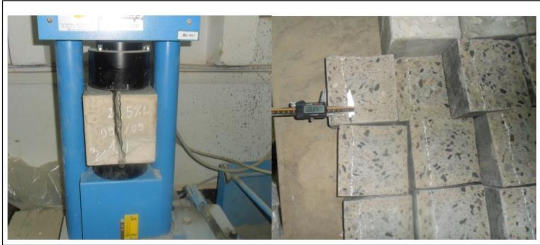
Figure 3.23 : Mesure de la profondeur de pénétration d'eau.
