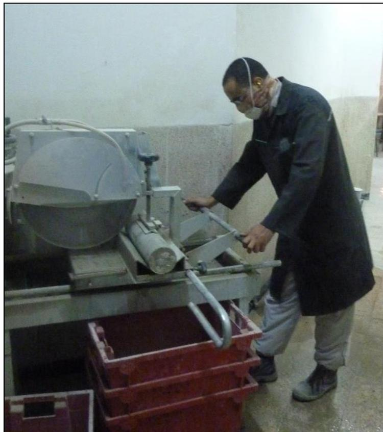
Figure 3.24 : Sciage des éprouvettes.
