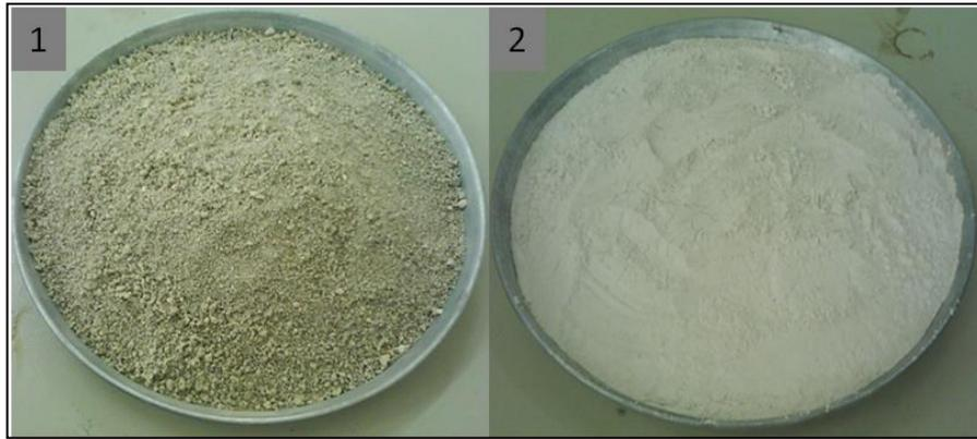
Figure 3.1 : Laitier granulé de haut fourneau utilisée : (1) avant broyage, (2) après broyage.
