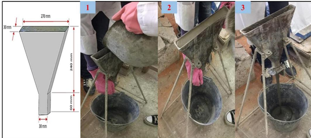
Figure 3.8 : Essai à l'Entonnoir en V pour Mortier.
