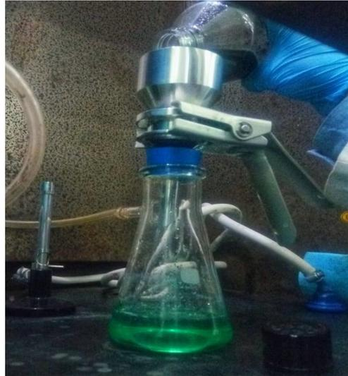
**Figure 5.6 :** Extraction des NTC bi-parois à partir de la poudre composite.
