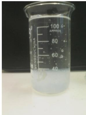
Figure 4.2 : Solution traitée par EC après 20 min de décantation.
