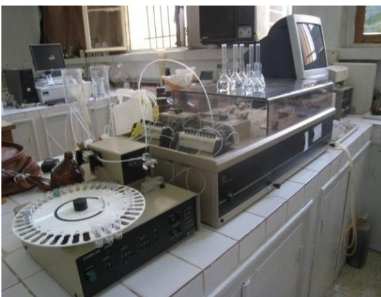
Photo d'un spectrophotomètre pour Le dosage des composés azotés
