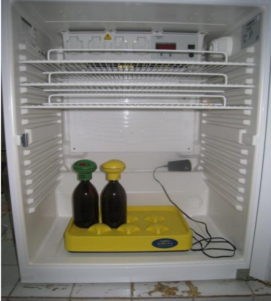
Photo d'une enceinte thermostatée Pour la mesure de la DBO
