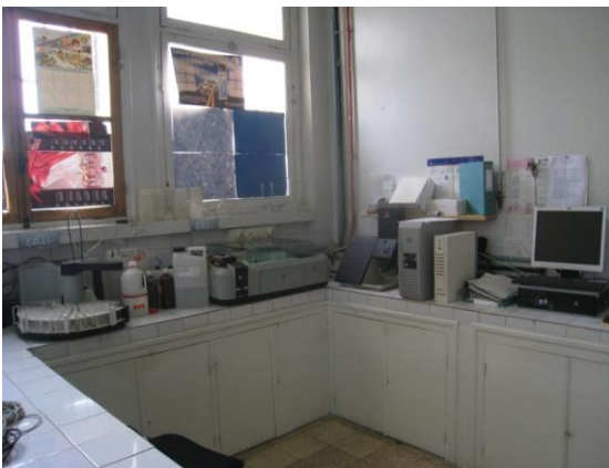
Photo d'un spectromètre à flamme pour le dosage des cations
