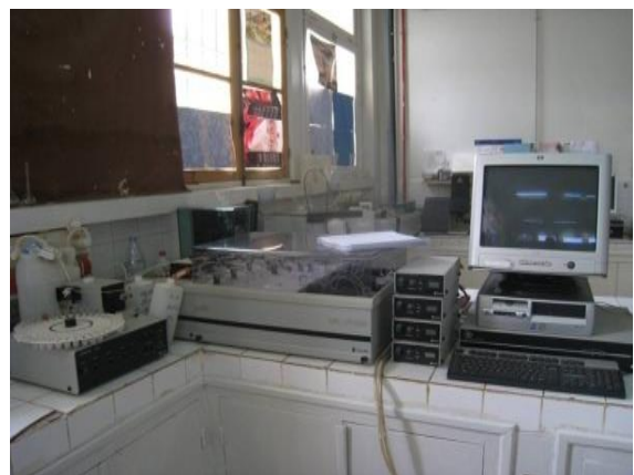
Photo d'un spectromètre à flamme pour le dosage des phosphates
