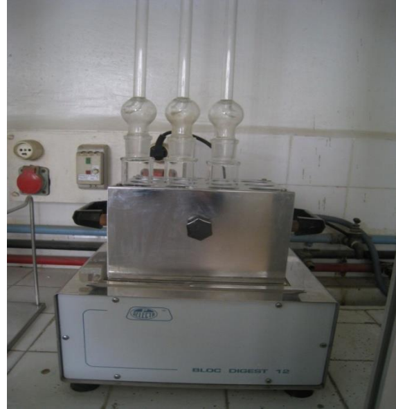
Photo d'un appareil pour la mesure de la DCO
