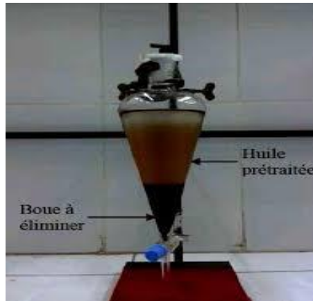
Figure3.14. :Sédimentation après traitement à l'acide de huile usagée.
