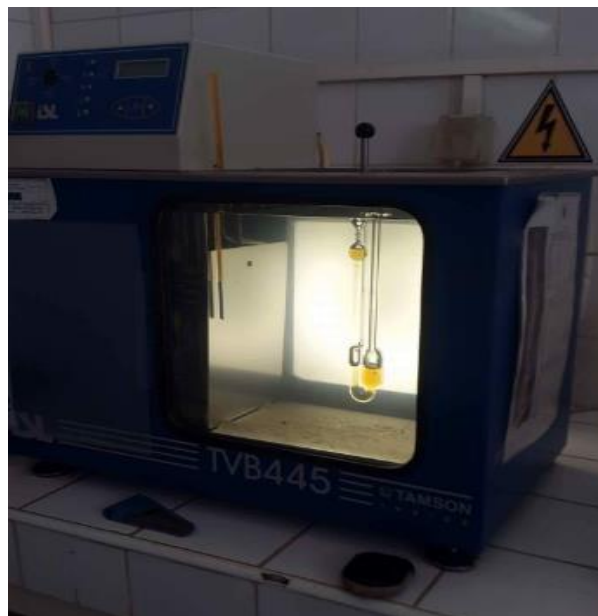
Figure 2.3 : bain de chauffe d'huiles de silicone
