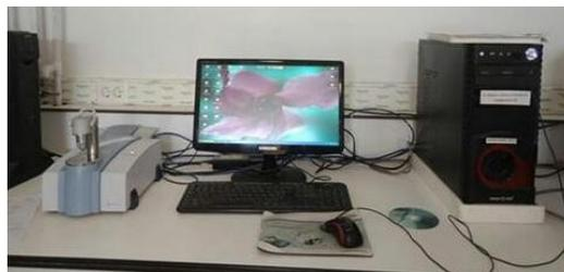
Figure II.3. Spectromètre infrarouge à transformée de Fourier (FTIR) ALPHA
