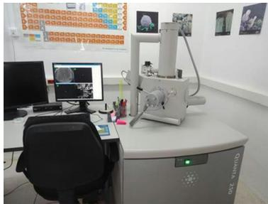
Figure II.2. Microscope Electronique à Balayage MEB-EDX (SEM-EDX)
