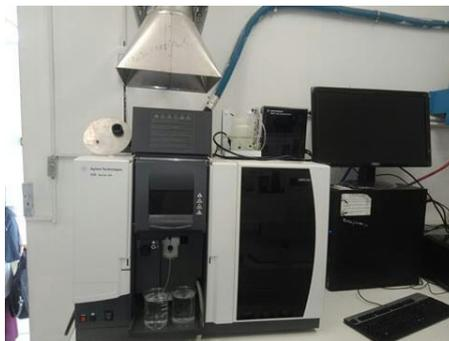
Figure II.6.: Spectromètre d'Absorption Atomique (SAA)
