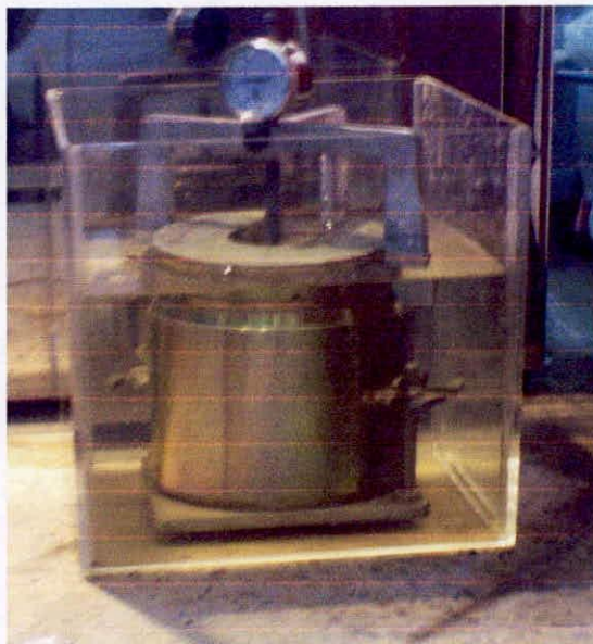
Figure 3.12: Sol compacté dans un moule CBR lors de son imbibation.
