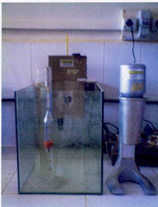
Figure 3.7: Un bac thermostatique contenant une éprouvette d'essai et un agitateur mécanique.
