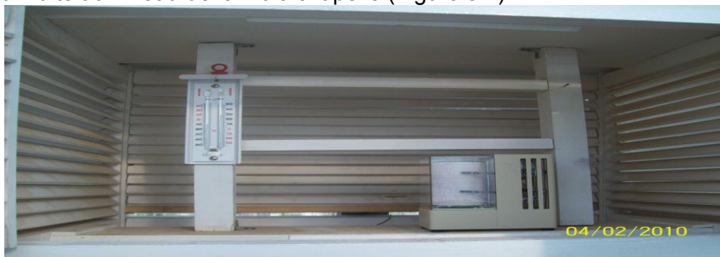
Figure 5.1: Thermomètre (Mini et Maxi) et Hygrographe (Originale, 2010).
