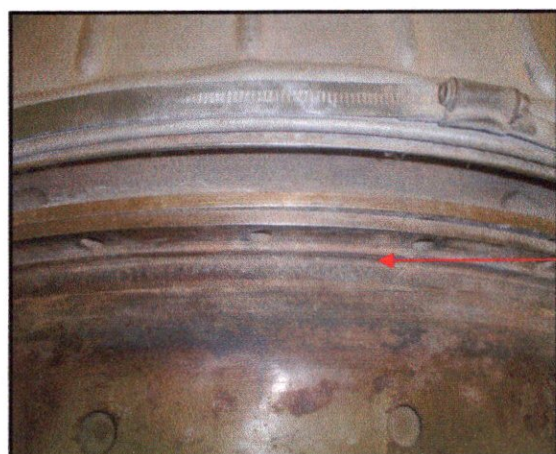
FIG.I.11- Soudure d'une chambre de combustion et flasque d'étanchéité.
