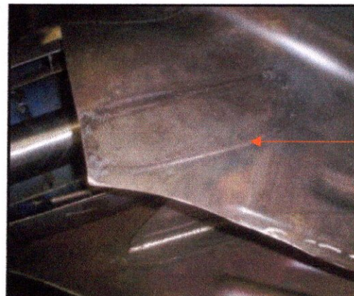
FIG.I.9- Soudure d'une tuyère d'échappement du turbopropulseur équipant l'hélicoptère MI-8.
