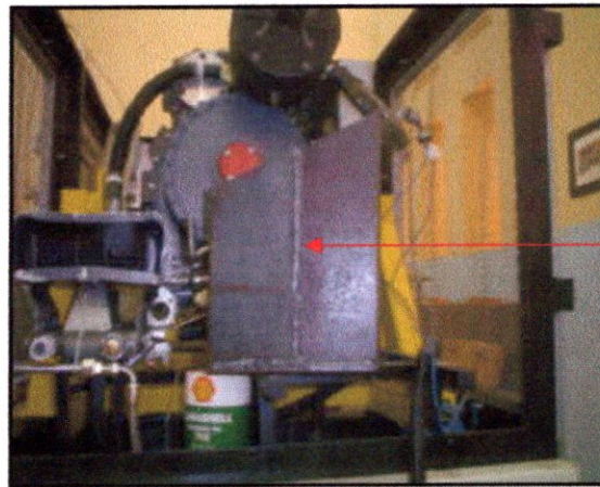
FIG.I.11- Soudure du réservoir d'huile du banc d'essai du moteur Artouste.
