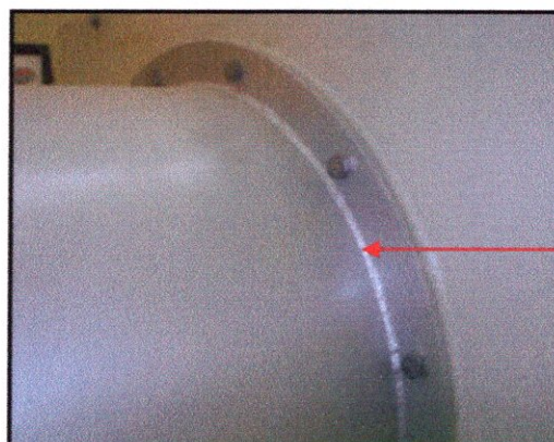
FIG.I.10- Soudure de la tuyère du banc d'essai du moteur Artouste.
