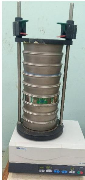
Figure : Tamiseur Retsch (AS 200)
