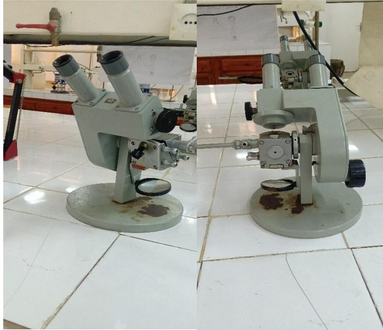
Figure : Refractomètre ABBE
