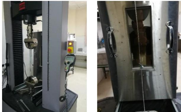
Figure 3.4 : Spécimen sous chargement
