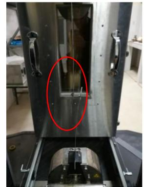
c) Cisaillement de la vis + déformation de la plaque
