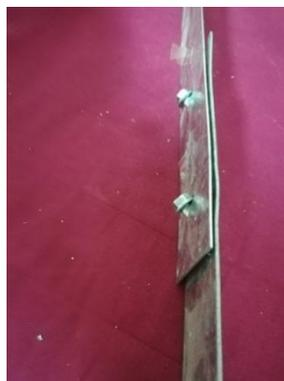
d) Rupture du profilé + inclinaison des deux vis
