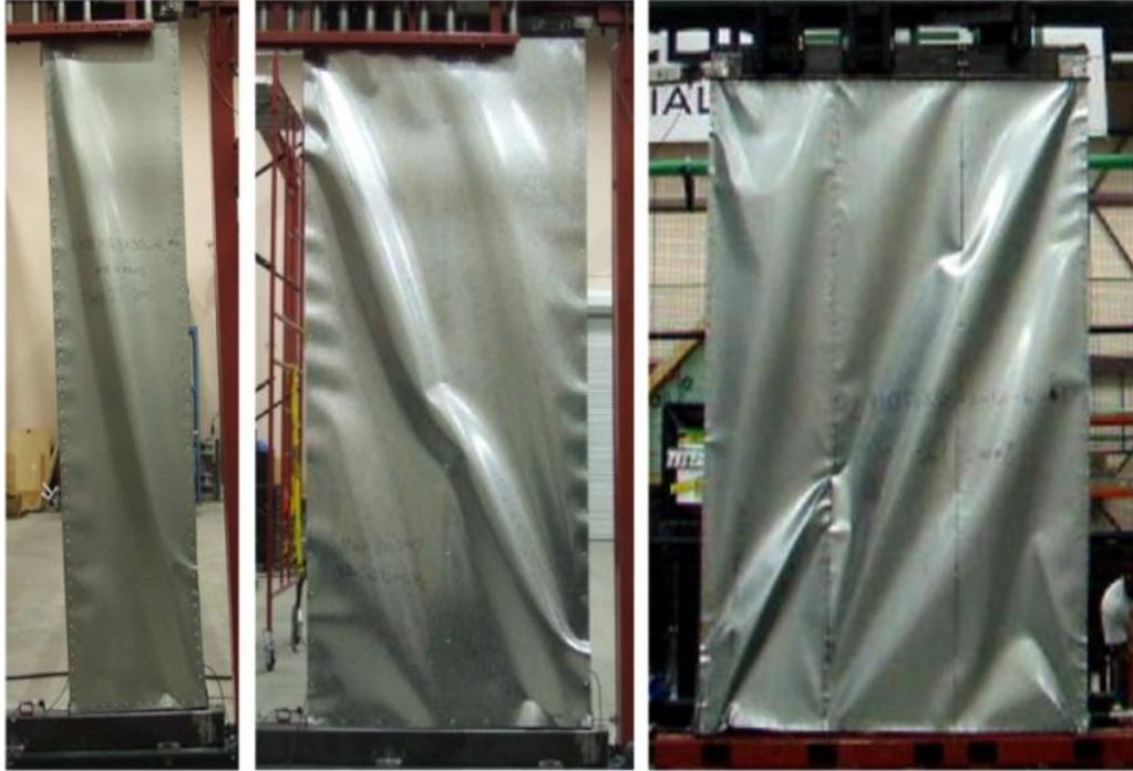
Figure 1.18 : Champ de tension (traction) dans la plaque structurale en acier [29]
