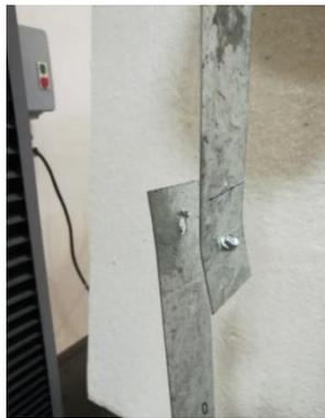
a) Rupture par cisaillement
