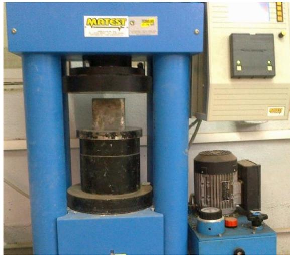
Fig II.14 : Essai de compression pour béton.
