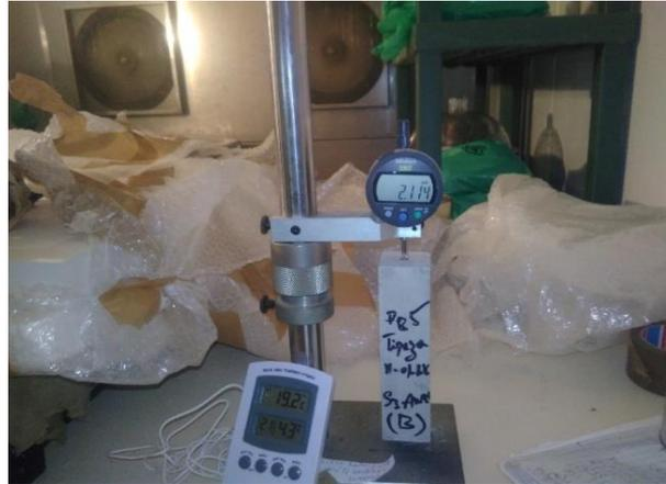
**Fig II.26 :** *Dispositif pour l'essai de retrait.*
