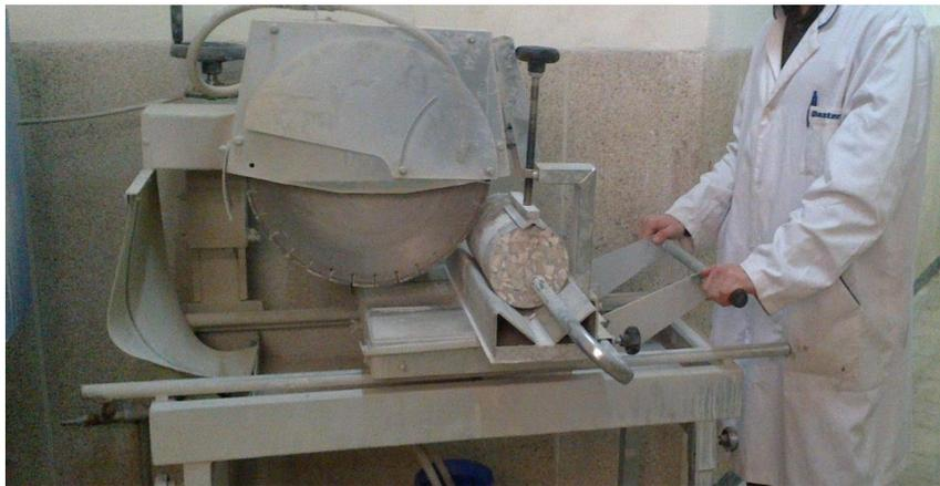
**Fig II.16** : Sciage des éprouvettes cylindriques de béton.
