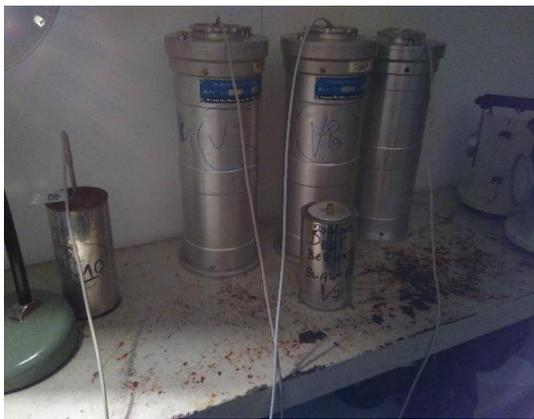
**Fig II.21 :** Calorimètre adiabatique à l'intérieur de la chambre climatique.
