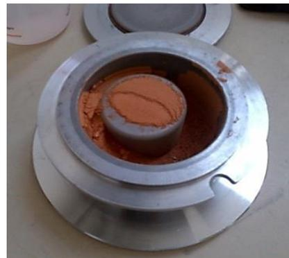
**Fig II.23 :** Vibrobroyeur à disque et sa garniture.
