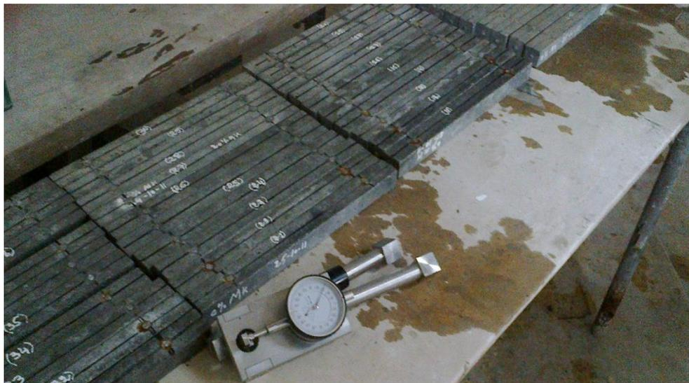
**Fig II.12 :** *Mesure de l'expansion des éprouvettes  $25 \times 25 \times 28 \text{ mm}^3$ .*
