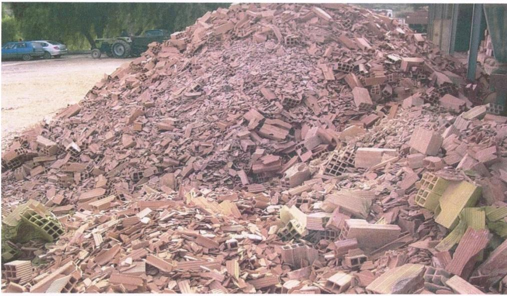
**Fig II.2 :** Déchets de brique de fabrication déposés aux alentours de la briquetterie.
