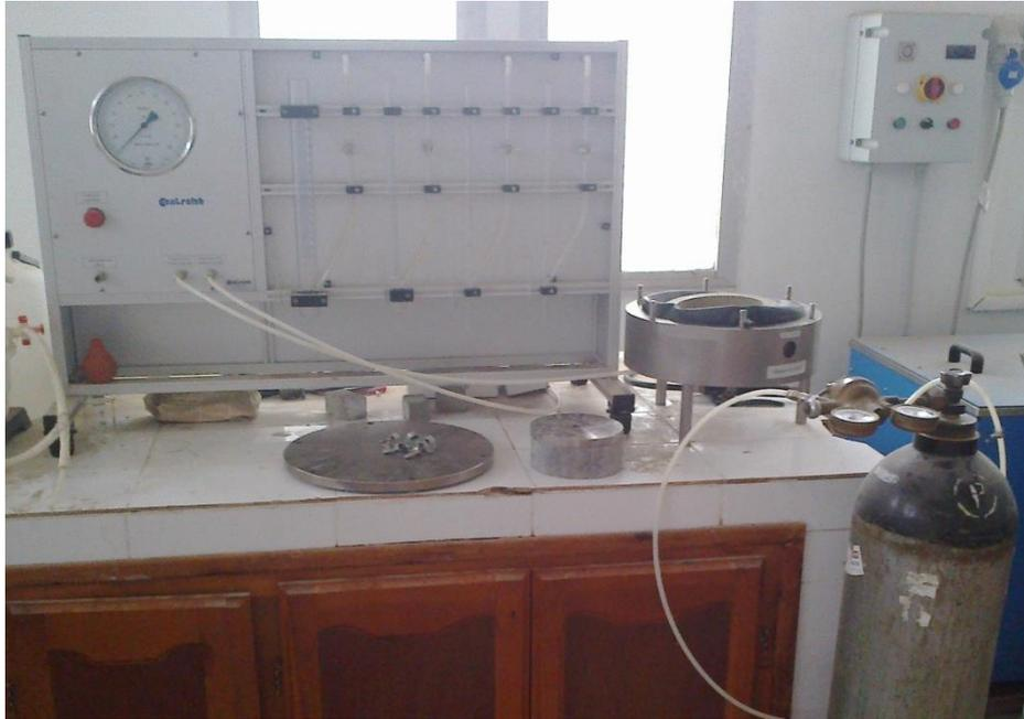
Fig II.17 : Appareillage de mesure de la perméabilité au gaz.
