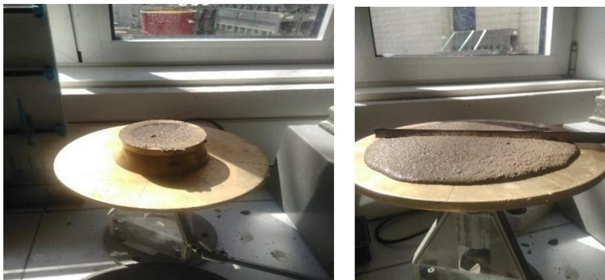
**Fig II.10 :** *Etalement de mortier.*
