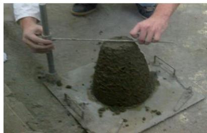
**Fig II.13** : Essai de consistance au cône d'Abrams.
