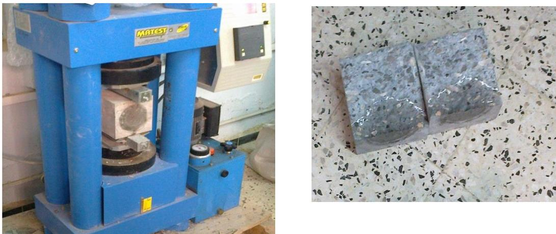
**Fig II.20** : Essai de traction par fendage (essai Brésilien).
