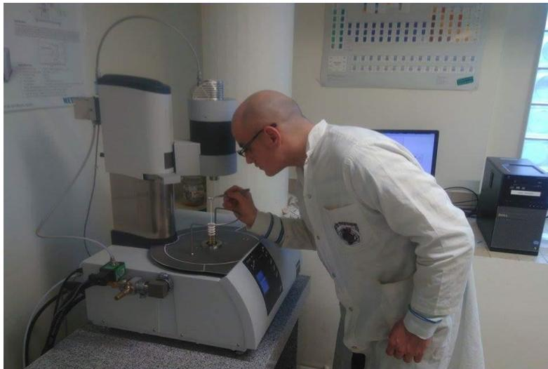
**Fig II.24 :** Machine utilisé pour l'essai ATD/ATG.
