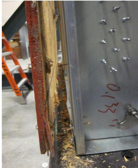
Figure 2.7: Réponse d'un SWP de 2,75 m x 2,44 m, séparation de la plaque de remplissage suite aux endommagements subis par les vis de fixation [11].
