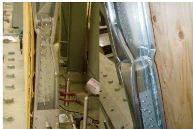
Figure 2.9 : Perte de stabilité du montant d'extrémité comprimé [20].
