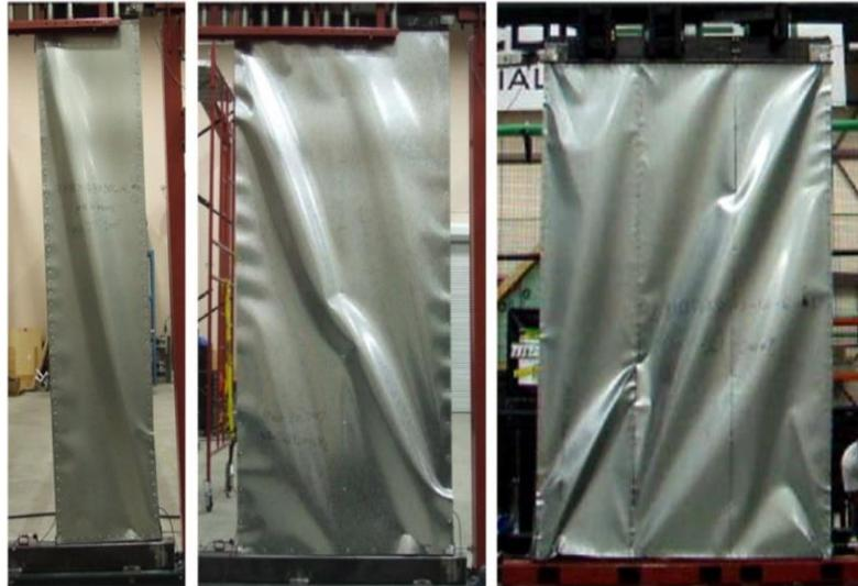
Figure 2.12 : Champ de traction d'un CFS-SSSWP [23].
