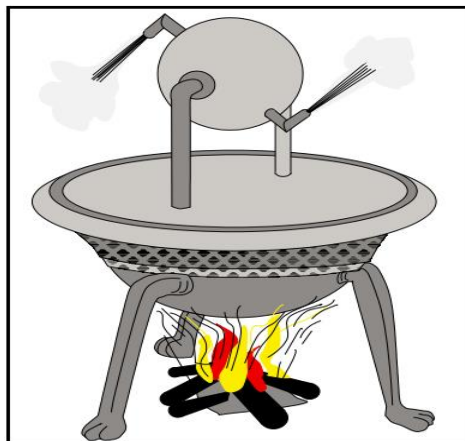
Figure.1.1 : moteur de HERO, premier Moteur à réaction, conçu autour de 250B.C.
