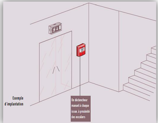
Figure 148 : Position du déclencheur manuel Source : index réglementation sécurité incendie ERP
