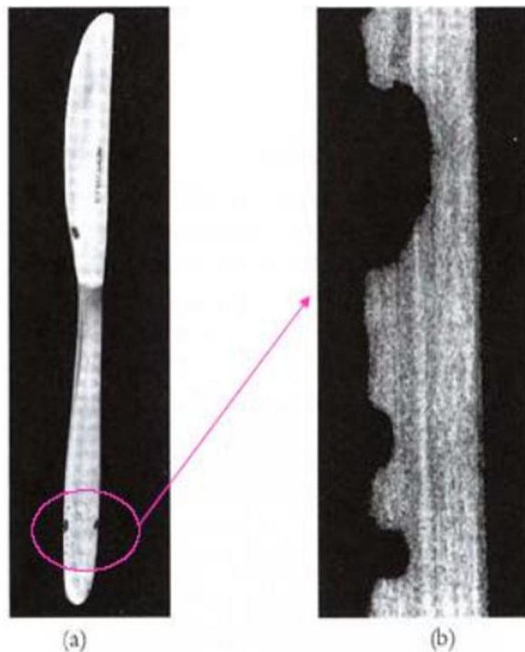
Figure I.13:a) Piqûres de corrosion sur un couteau en acier inoxydable (12% Cr).
