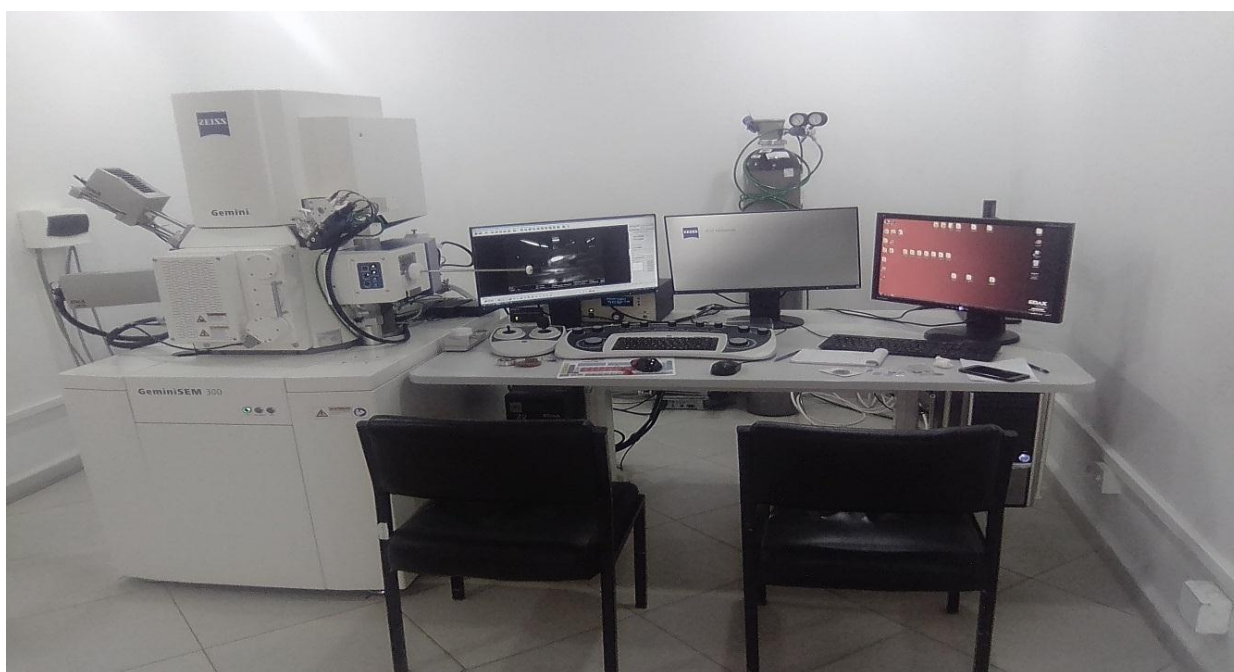
Figure II.11 Microscope électronique à balayage GEMINI SEM 300
