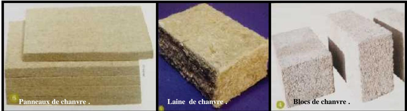
Figure I.30: Les isolants en chanvre .
