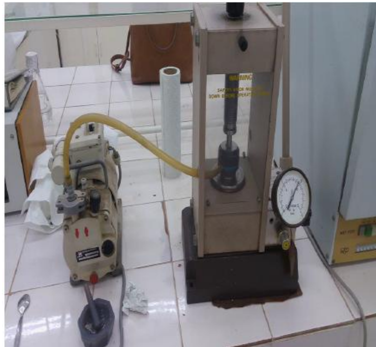
Figure A.8 : pastilleuse de laboratoire pour Préparation les échantillons Analysés en Spectroscopie infrarouge (FTIR)
