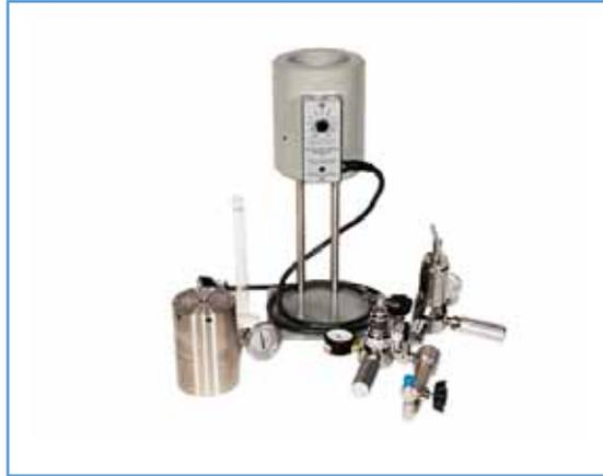
Filtre presse haute pression haute température
