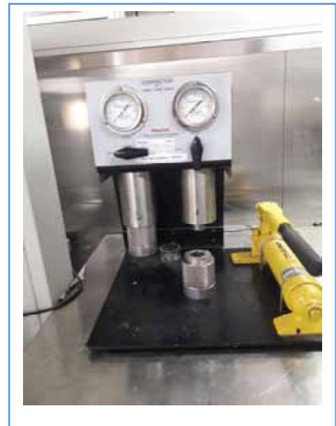
Presse hydraulique pour la compaction des pastilles
