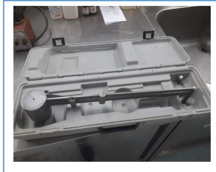
Figure 3.3 : Densimètre de boue (Mud balance)
