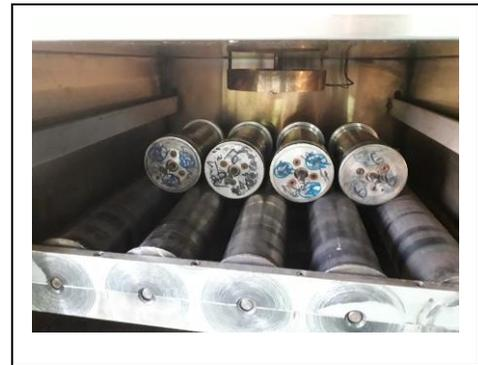
Figure 3.2 : Cellules dans le four rotatif (Hot Rolling)
