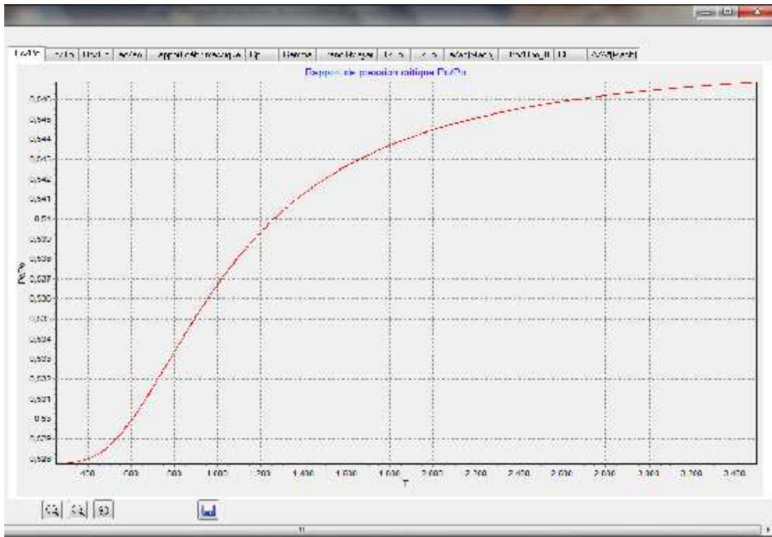
Figure 2 : rapport des pressions critiques en fonction de température génératrice tracé par PGR
