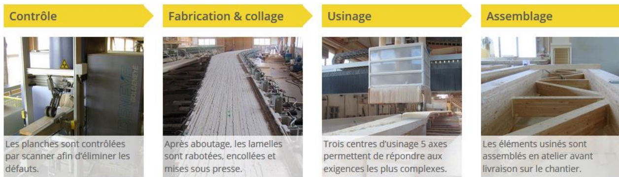
Figure 148 : les étapes de production du lamellé collé. Source : Google image.
