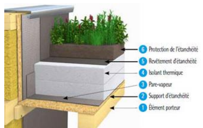
Figure 147 : détail constructif. Source ; Google image
