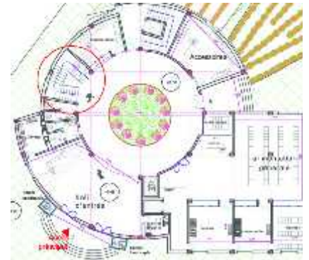
Figure 87: escalier dans le rôle d'issue de secours dans le RDC Source : auteurs
