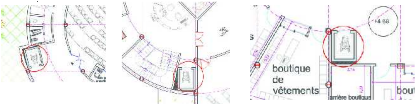
Figure 90: les ascenseurs pour personnes à mobilité réduite dans les différents plans Source : auteurs
