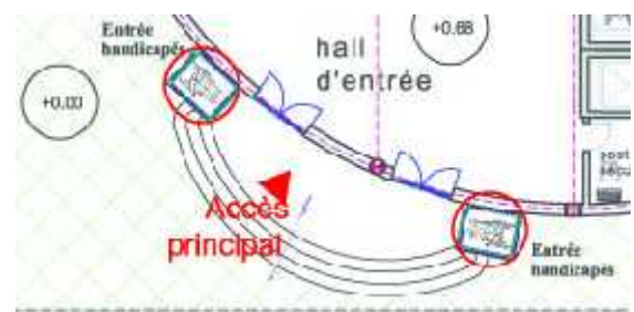
Figure 88: entrée principale pour personnes à mobilité réduite dans l'entité centrale Source : auteurs
