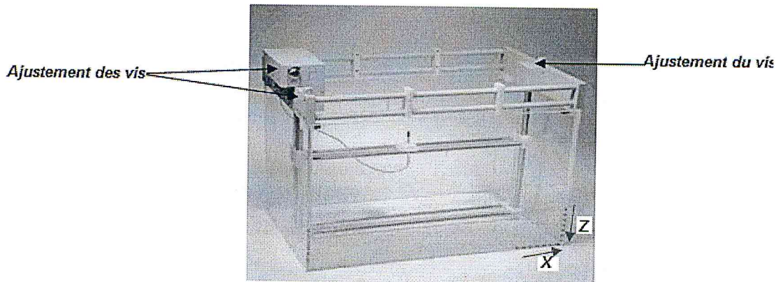
Figure III.39 : La cuve d'eau, le Servo 2D et le détecteur dans son support [64].
