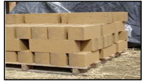
Figure 11: Séchage des blocs (Source : http://www.appro-techno.be/ )
