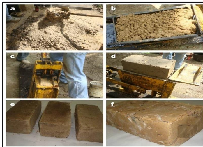
Figure 21: Les étapes de fabrication des Blocs de Terre Comprimée (Source: CNERIB Algérie)
