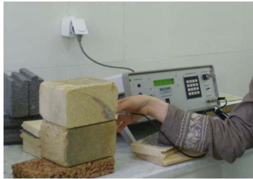
Figure 13: Réalisation des essais avec le CT-mètre au CNERIB, (Source : auteur)
