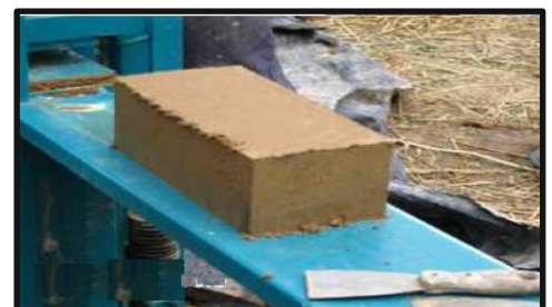
Figure 10: Démoulage des blocs (Source : http://www.appro-techno.be/ )
