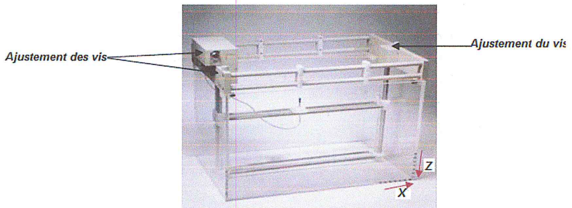
Fig.43.La cuve d'eau, le Servo 2D et le détecteur dans son support [24].
